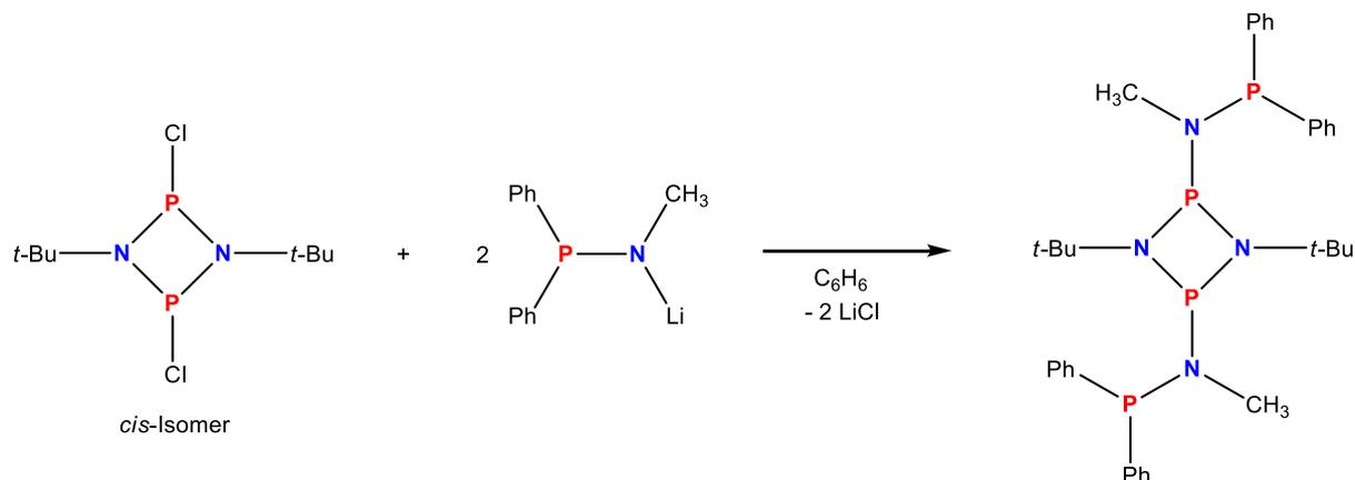
**Schema 33.** Synthese von *cis/trans*-[MeN(PPh<sub>2</sub>)P( $\mu$ -N*t*-Bu)]<sub>2</sub> nach Keat *et al.*<sup>[54]</sup>
