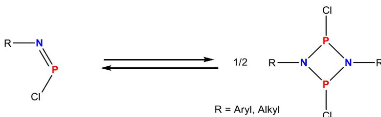
**Schema 4.** Formales Monomer-Dimer-Gleichgewicht zwischen Iminophosphan und *cyclo*-Diphosphadiazan.
