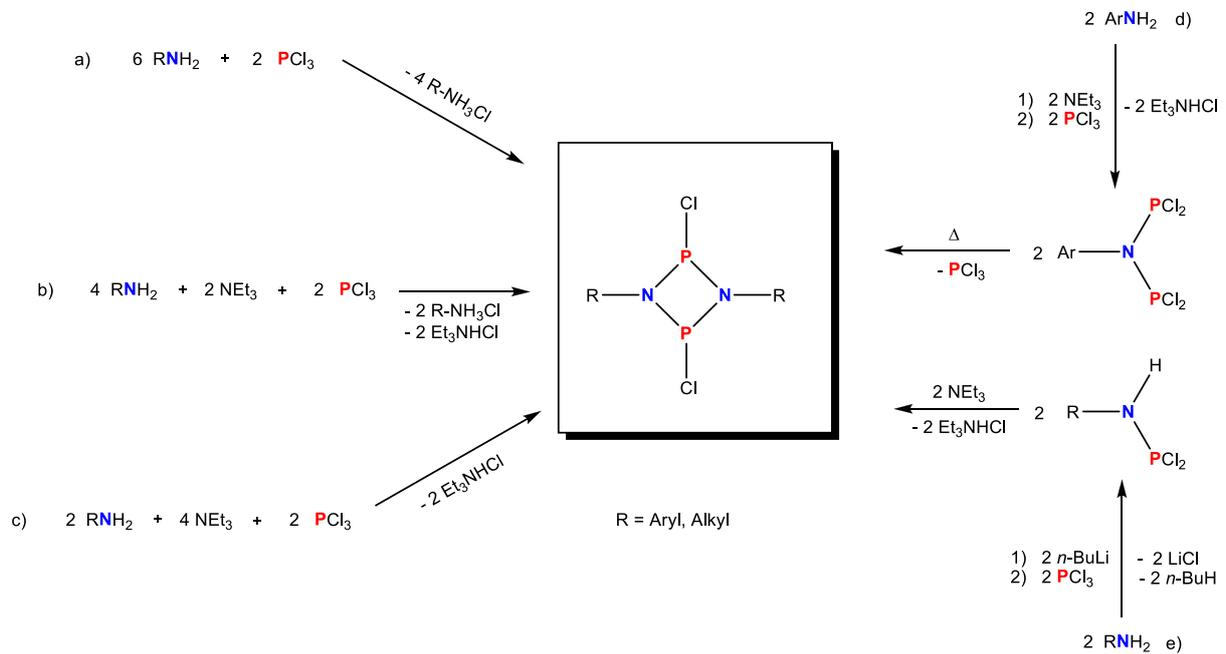
**Schema 6.** Übersicht über die Darstellungsmöglichkeiten zur Herstellung von *cyclo*-Diphosphadiazanen  $[\text{ClP}(\mu\text{-NR})_2]$ .
