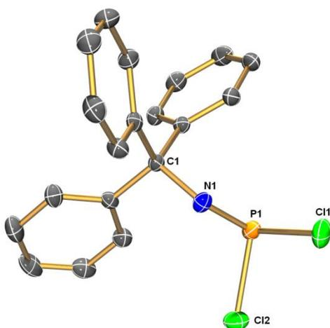
**Abbildung 15.** ORTEP-Darstellung der Molekülstruktur von **20** im Kristall mit Atomnummerierung. Verschiebungsellipsoide (bei 173 K) sind bei 50 % Wahrscheinlichkeit gezeichnet (H-Atome sind nicht dargestellt). Ausgewählte Bindungslängen [ $\text{\AA}$ ] und Bindungswinkel [ $^\circ$ ]: P1–N1  $1.646(2)$ , P1–Cl2  $2.0818(7)$ , P1–Cl1  $2.0897(7)$ , C1–N1  $1.499(2)$ ; C1–N1–P1  $124.7(1)$ , C1–N1–H1  $117(2)$ , P1–N1–H1  $115(2)$ .
