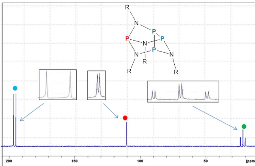
**Abbildung 17.** <sup>31</sup>P-NMR-Spektrum der Reaktion von **15N**(SiMe<sub>3</sub>)<sub>2</sub> mit Magnesium in THF nach 24 Stunden.
