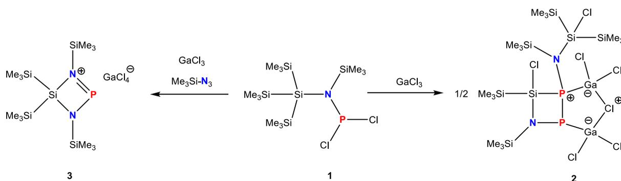
**Schema 1.** Reaktionen von **1** mit  $\text{GaCl}_3$  unter Eliminierung von  $\text{Me}_3\text{SiCl}$  und koordinativer Absättigung des Lewis-sauren Zentrums. Links: Si-N-Bindungsknüpfung unter Ausbildung eines cyclischen Bis(amino)phosphonium-Kations in Gegenwart von  $\text{Me}_3\text{Si-N}_3$ . Rechts: Bicyclisierung unter Si-P- und Ga-P-Bindungsknüpfung.
