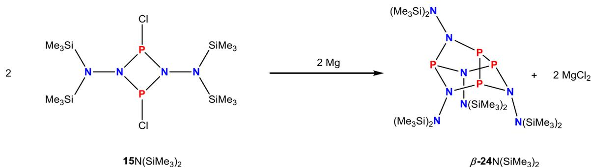
**Schema 40.** Reduktion von **15N**(SiMe<sub>3</sub>)<sub>2</sub> mit Magnesium zur achtgliedrigen Käfigverbindung  $\beta$ -**24N**(SiMe<sub>3</sub>)<sub>2</sub>.
