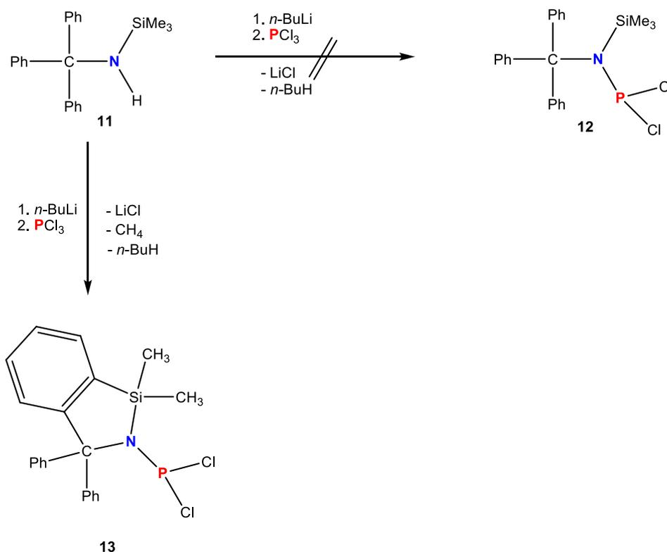
**Schema 30.** Reaktion von Trit-N(SiMe<sub>3</sub>)H mit *n*-BuLi und PCl<sub>3</sub> zur bicyclischen Verbindung **13**.
