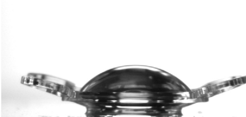
Abb. 32: Kontaktwinkelausbildung an einer Technoko Yellow Flex
