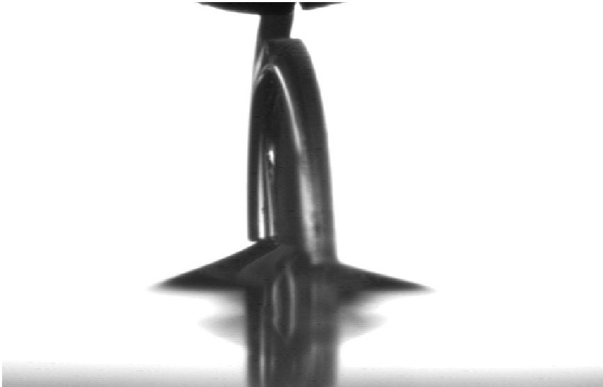
Abb. 36: Meniskuswinkel am Beispiel der Tecnis-1-piece ZCB00 (hydrophob)
