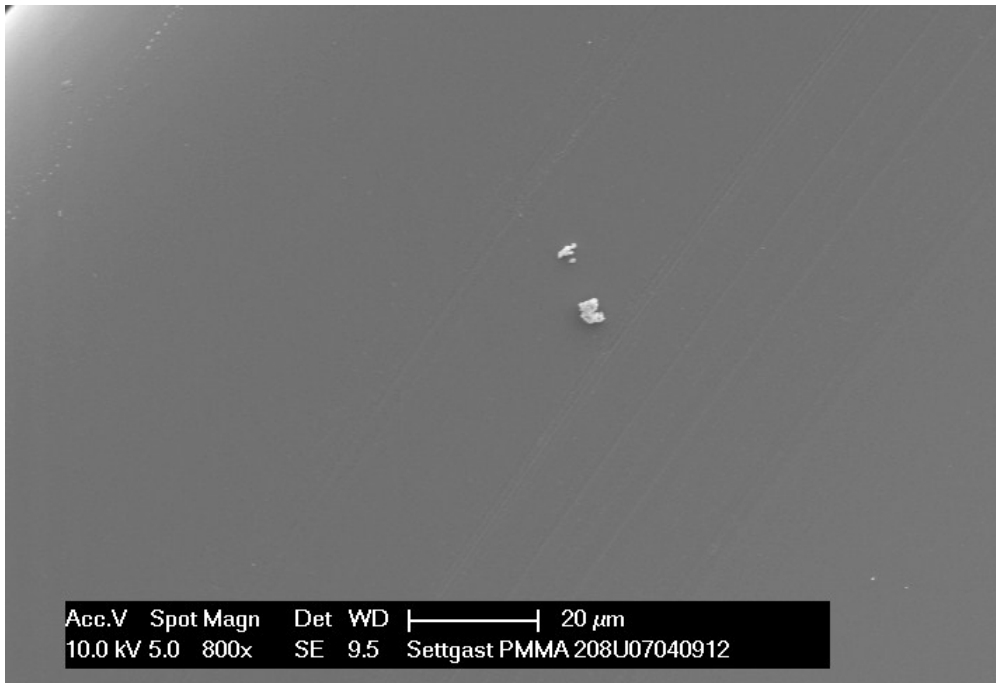
Abb. 60: Optikoberfläche im REM am Beispiel der Rayner 755 U im Maßstab 20 µm
