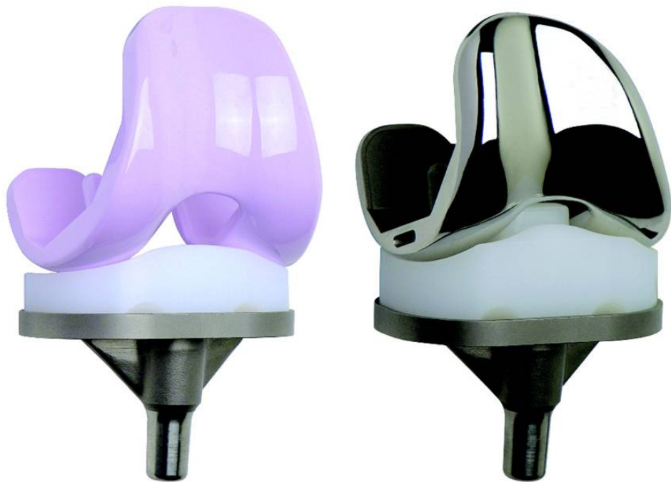
Abb. 2.1.1: Multigen Plus Knee mit einer symmetrischen Biolo x ® Delta Keramik Femurkondyle (links) und einer asymmetrischen Femurkondyle aus Co28Cr6Mo (rechts). Das Polyethyleninlay und die metallische tibiale Komponente aus TiAl6V4 sind jeweils identisch.
