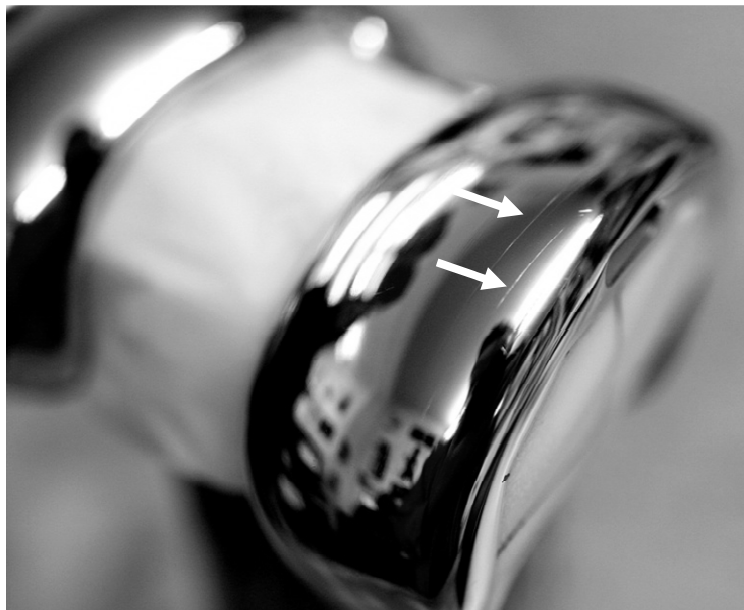
Abb. 3.1.3.5: Femurkomponente aus Co28Cr6Mo nach 5 Millionen Belastungszyklen unter Anwesenheit von Drittkörpern mit sichtbaren Kratzern auf der Belastungsfläche [161].
