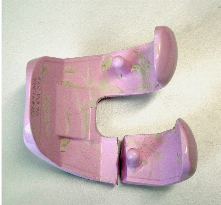
Abb. 4.1.1: Bruch einer BioloX ® Delta Femurkomponente beim sog. wedge loading durch fehlerhafte knöcherne Präparation und hohe Impulseinwirkung durch Einschlagen mit einem Hammer [23].
