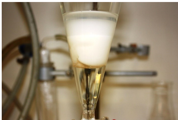
Abbildung 4-10: Bildung einer persistenten Schaumphase bei zu heftiger Durchmischung.
