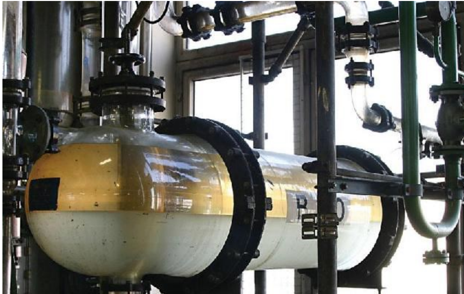
Abbildung 2-4: Foto des Phasenabschieders im BASIL™ Prozess [8].
