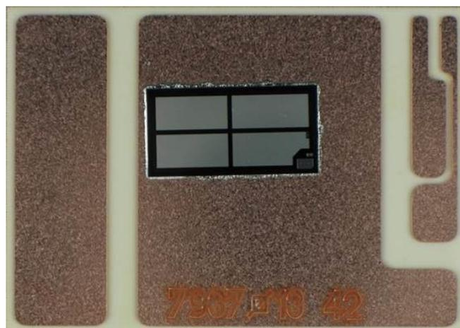
Abbildung 5.52: Keramisches Substrat mit aufgelötetem IGBT-Barrierenchip.
