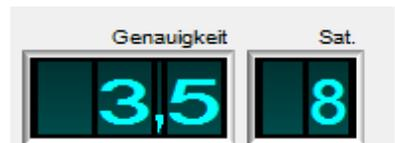
Abbildung 69: Anzeige „mdCockpit“ absolute GNSS-Genauigkeit in [m] und Anzahl der empfangenen Satelliten
