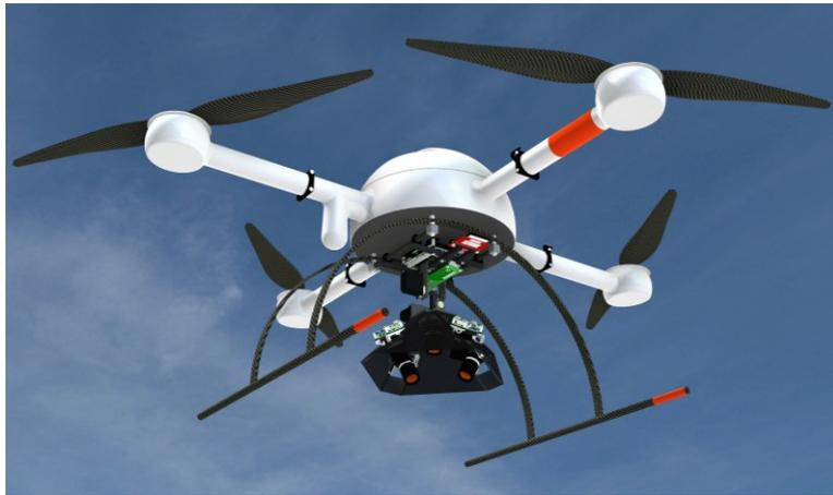
Abbildung 62: Entwurf "Four Vision"-Kamerasystem unter MD4-1000
