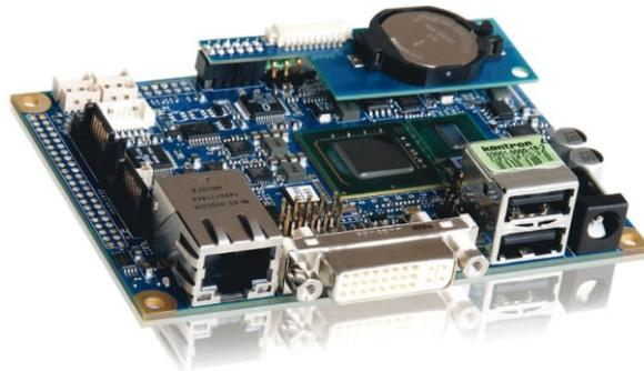
**Abbildung 58: Pico-ITX-Board, 1.6 GHz Intel® Atom™ Z510 / 530 Prozessor, 6 USB 2.0, 2 SATA-Ports, 1 PATA44-Port, 1 GByte RAM<sup>28</sup>**
