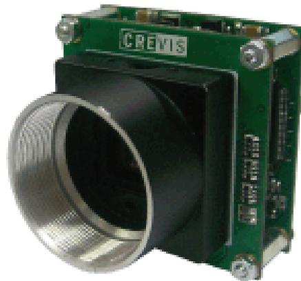
Abbildung 52: MV-CS27U von der Firma Crevis (MaxxVision, 2013a)
