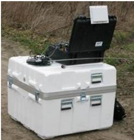
Abbildung 50: MD4-1000 Basisstation zur Überwachung der UAV-Telemetriedaten
