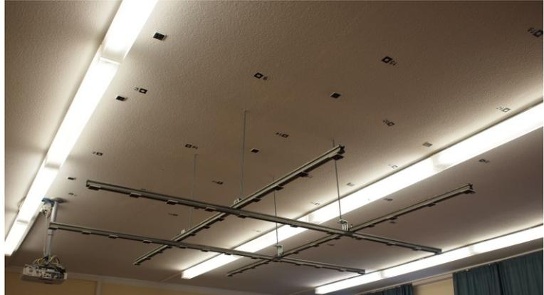
Abbildung 8: Kalibriervorrichtung der Professur für Geodäsie und Geoinformatik
