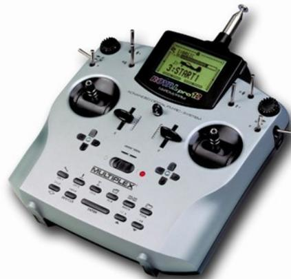
Abbildung 51: Fernbedienung für MD4-1000 auf 35Mhz <sup>27</sup>
