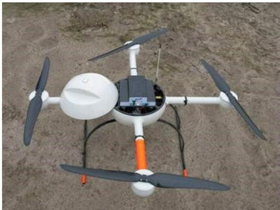
Abbildung 48: MD4-1000 mit offenem Gehäuse
