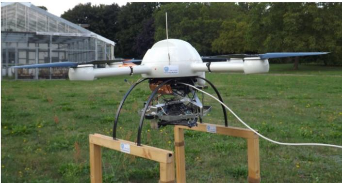
Abbildung 95: MD4-1000 mit „Four Vision“-Kamerasystem und LAN-Verbindung kurz vor Flug über Campus (Quelle: (JAKOBI, 2013))
