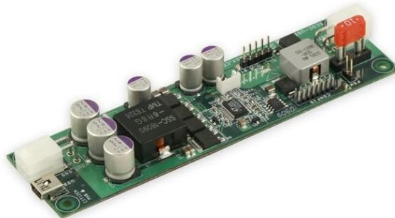
Abbildung 59: DC-DC Netzteil<sup>30</sup>
