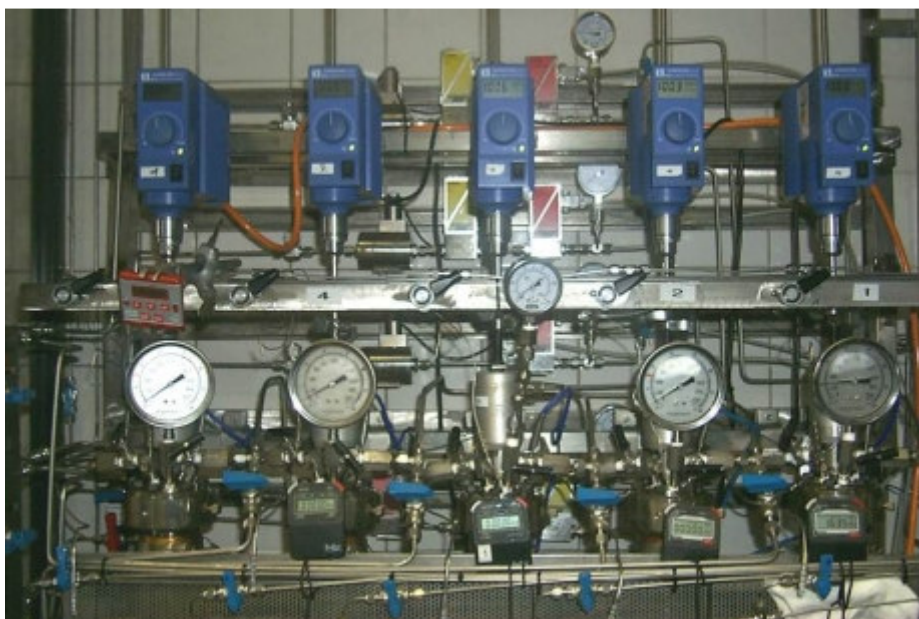
Abbildung 17: Mehrfachautoklavensystem mit automatischer Probennahme der Evonik Oxeno GmbH
