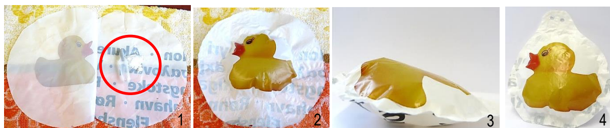
Abb. 96: Tütenvorderseite und -rückseite mit Pipettenkopf und Soda (Bild 1), Beutel nach Auslösen der Reaktion (Bild 2), Gasvolumen nach ca. 2 Min. (Bild 3), Dekokugel (zurechtgeschnitten, Bild 4)
