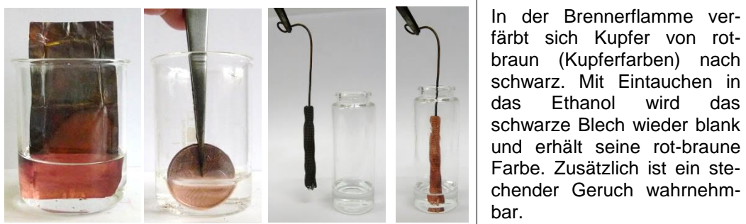
Abb. 73: Reaktion von Ethanol mit CuO
