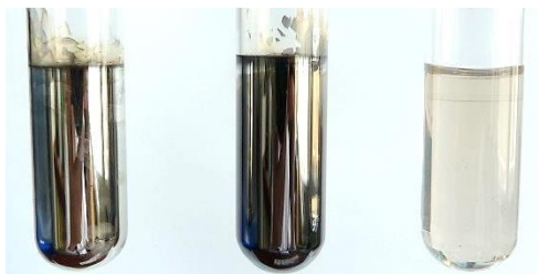
Abb. 77: oxidierte Alkohollösungen mit Tollenz-Reagenz (v. l.: Ethanol, Propan-1-ol, Propan-2-ol)
