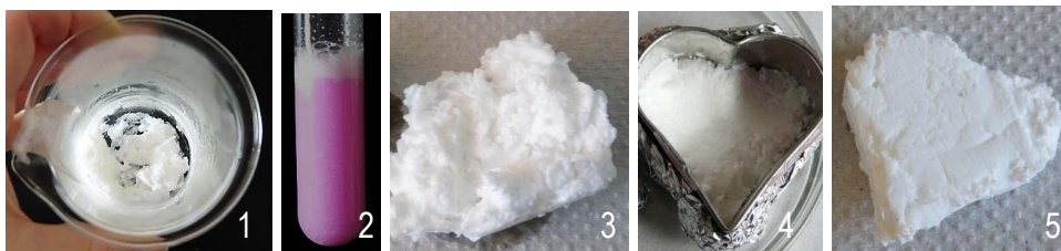
Abb. 87: entstehender Salzkern im Becherglas (Bild 1), Schaumbildung im Reagenzglas (Bild 2), abgeschöpfter Salzkern (Bild 3), Salzkern in Plätzchenform (Bild 4), Salzkern getrocknet (Bild 5)
