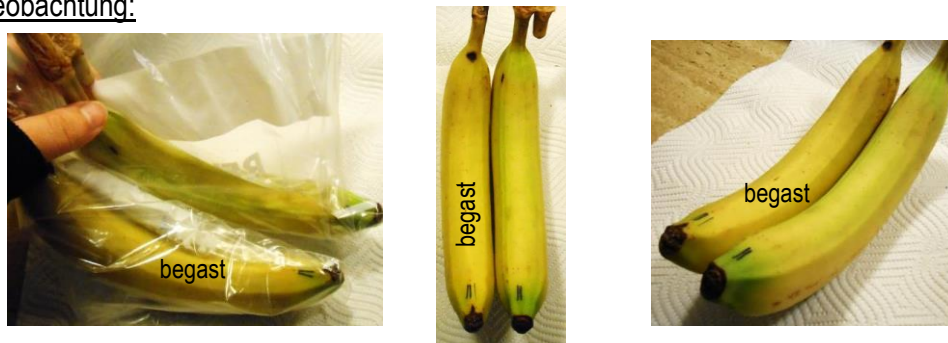
Abb. 56: mit und ohne PE-Pyrolysegas versehene Bananen nach 5 Tagen
