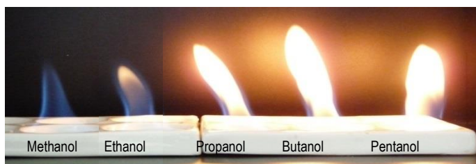
Abb. 19: Flammenfarben der Alkohole der homologen Reihe
