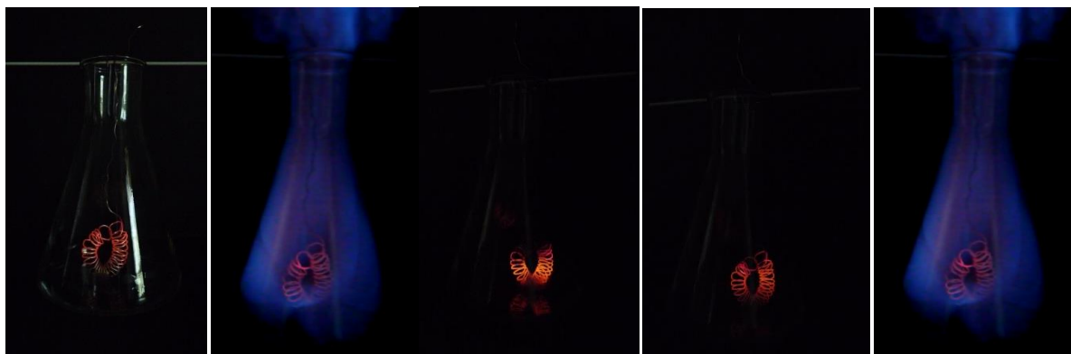
Abb. 75: Abwechselndes Aufglühen der Kupferspirale samt Verpuffung
