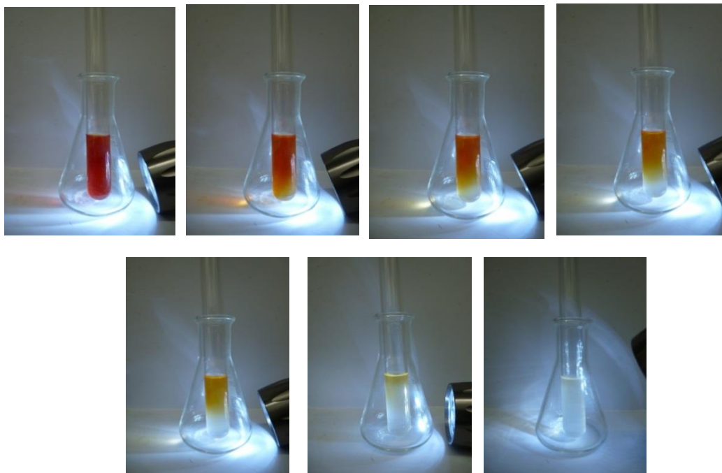
Abb. 63: Entfärbung mittels tragbarer Fahrradlampe mit zunehmender Zeit
