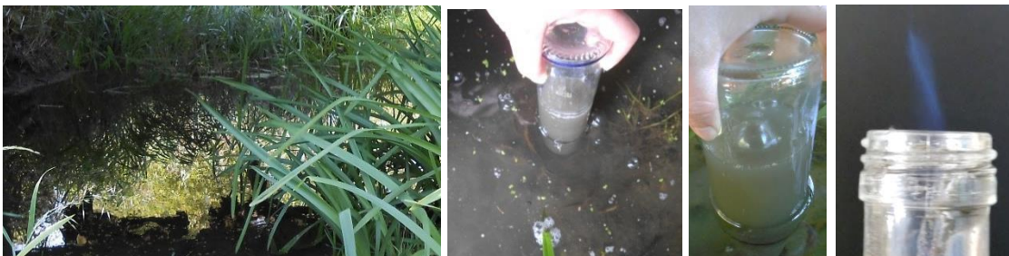
Abb. 51: stehendes Gewässer (l.); Sammeln von Methangas mit aufsteigenden Gasblasen (m.) und Verbrennung des gesammelten Gases im Labor (r.)
