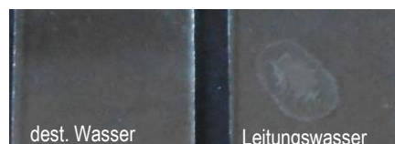
Abb. 89: eingedampfte Tropfen (dest. Wasser l., Leitungswasser r.) auf einem Objektträgerglas
