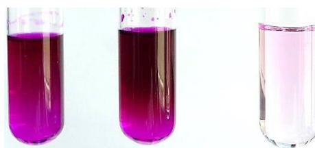
Abb. 78: oxidierte Alkohollösungen mit Schiffs-Reagenz (v. l.: Ethanol, Propan-1-ol, Propan-2-ol)
