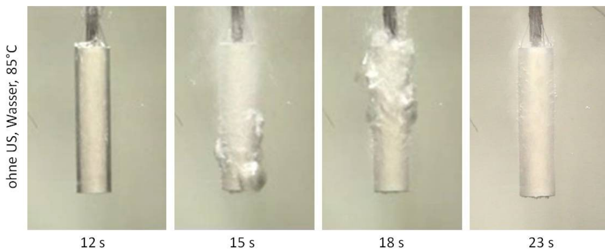
Abbildung 28: Bilderserie der konventionellen Wasserabschreckung von EN AW-6082 bei 85 °C.
