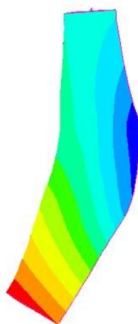
Abbildung 112: Verformung eines X5CrNi18-10-Zylinders in Beschallungsrichtung während einer einseitig ultraschallunterstützten Wasserabschreckung bei 60 °C.
