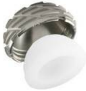
Abbildung 2: Metallisches Schraubpfannengehäuse Trident™ TC (Stryker®) bestehend aus einer TiAl6V4 Schmiedelegierung mit Pfannen-Einsatz aus sequentiell hochvernetztem Polyethylen (Stryker®).
