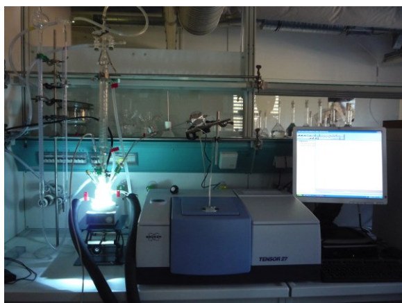
Abbildung 2.2: Foto und schematische Darstellung der in situ Spektroskopie mit simultaner Gasmessung.
