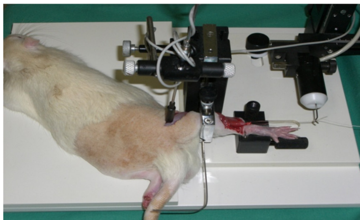
Abbildung 15: Versuchseinrichtung mit biomechanischer Kraftmessung an der Ratte. Zur indirekten Stimulation des M. soleus wurde der N. ischiadicus in eine gebogene Elektrode eingelegt. Der M. soleus wurde durch Anbringen einer Naht am Sehnenansatz in die Versuchseinrichtung eingespannt. Während computerunterstützter Gabe von elektrischen Reizen wurde die resultierende Muskelkraft -transferiert durch eine Messeinrichtung- digital aufgenommen.
