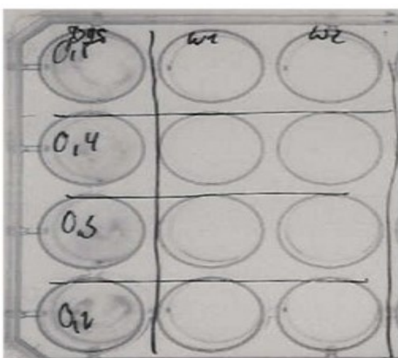
Abbildung 35: Ergebnis der Bestimmung der Biofilm-Masse in den einzelnen Kavitäten. Nach Durchführung der Ozonapplikation erfolgte die Bestimmung der Lebendkeimzahlen. Makroskopisch konnte keine Biofilmbildung im zweiten und dritten Näpfchen detektiert werden
