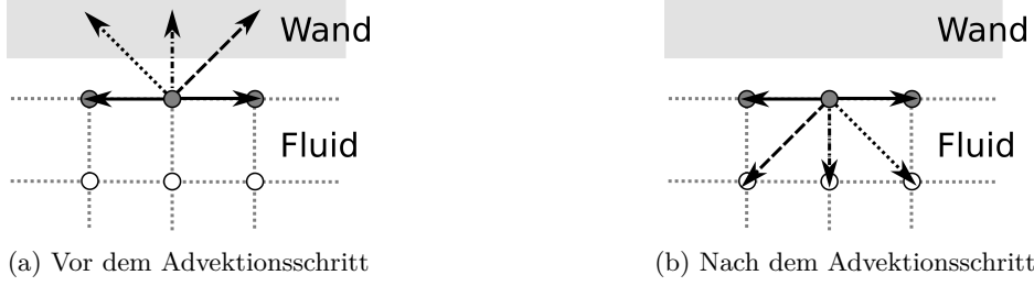
Abbildung 2.5: Schema der bounce back Randbedingungen. Die Verteilungsfunktionen, welche den Simulationsbereich im Normalfall verlassen würden, sind unterschiedlich gekennzeichnet, um deren jeweiliges Verhalten beim Advektionsschritt zu verdeutlichen.
