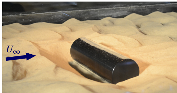
Abbildung 5.3: Im Wasserkanal ermittelte charakteristische Versandungsstrukturen im Umfeld eines liegenden Zylinders.
