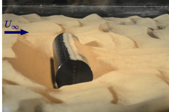
Abbildung 4.5: Quasi-stationärer Endzustand der Versandung eines liegenden Zylinders im Wassserkanal.
