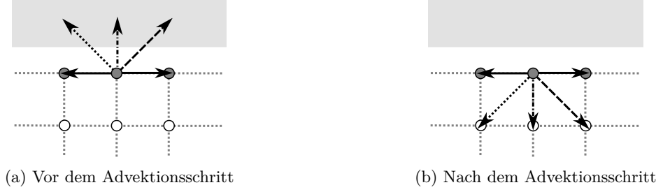
Abbildung 2.6: Schema der free-slip Randbedingungen, basierend auf dem Prinzip der specular reflection . Die Verteilungsfunktionen, welche den Simulationsbereich im Normalfall verlassen würden, sind unterschiedlich gekennzeichnet, um deren jeweiliges Verhalten beim Advektionsschritt zu verdeutlichen.
