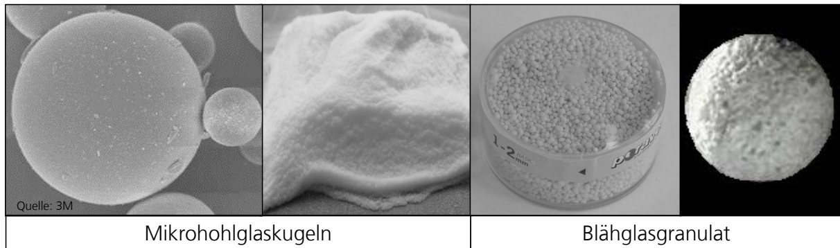
Abbildung 28: Mikrohohlglaskugeln vergrößert (li.), Mikrohohlglaskugeln Schüttmenge (mi. li.), Blähglasgranulat Schüttmenge (mi. re.) und Blähglasgranulat vergrößert (re.)
