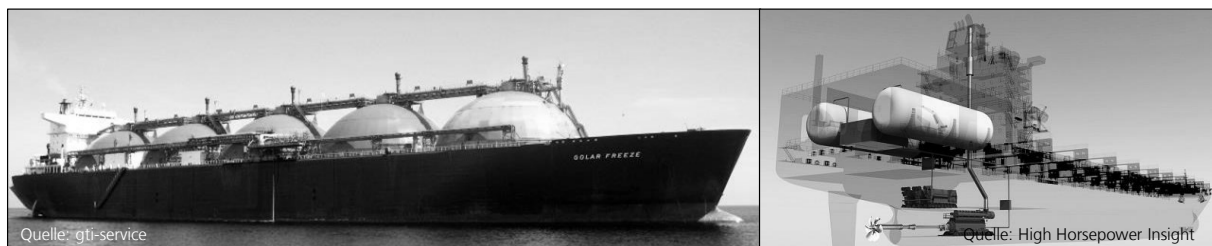
Abbildung 1: LNG-Transportschiff - Typ Moss (li.), LNG Treibstofftanks für einen Schiffsantrieb (re.)
