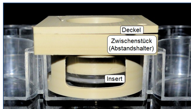
Abbildung 7 Co-Kultur-System mit Peek-Teilen
