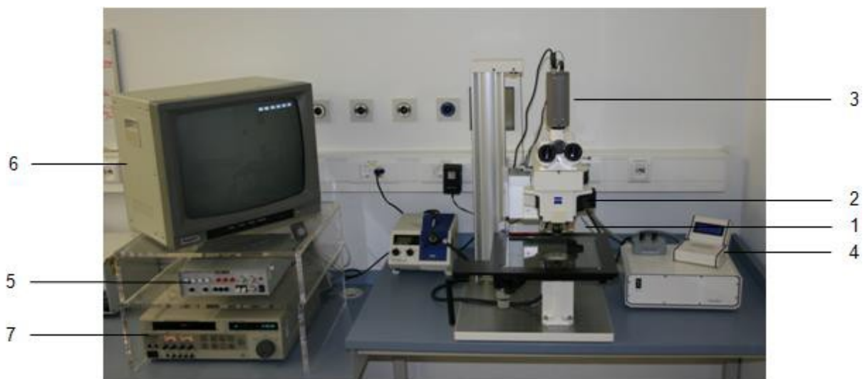
Abbildung 8: Versuchsaufbau der intravitalen Fluoreszenzmikroskopie: Der Versuchsaufbau besteht aus dem Mikroskop (Axiotech® Vario 100; Zeiss; Göttingen; Deutschland) inklusive Objektivrevolver (1), Lichtfiltersystem (2) für verschiedene Exzitations- und Emissionsmaxima, sowie einer CCD Kamera (3), welche über einen Echtzeitgenerator (5) mit einem Monitor (6) und einem DVD-Rekorder (7) verbunden ist. Anbei befindet sich ein Steuerelement für die Belichtungsintensität (4).
