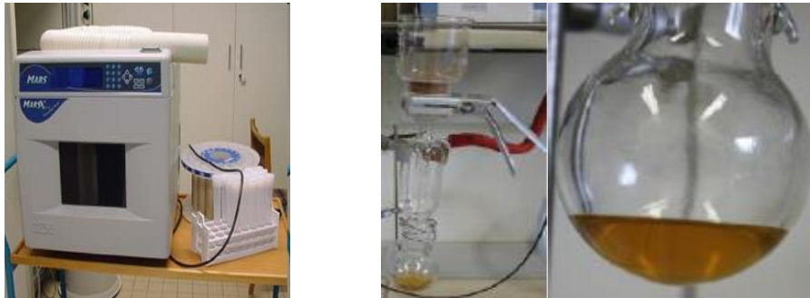
Abb. 10 links - MarsExpress von CEM; rechts - Membranfiltrationsanlage von Millipore, (mit freundlicher Genehmigung durch C. Oppermann)
