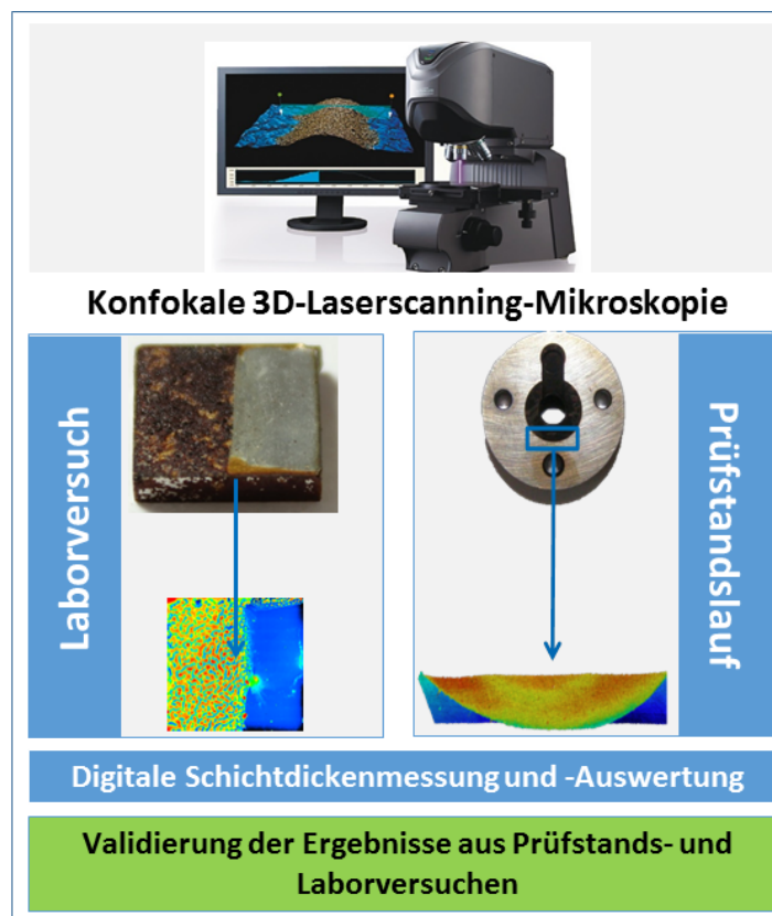
Abbildung 8.2: Messung und dreidimensionale Bilderzeugung von Ablagerungen auf Prüfplättchen aus Laborversuchen und Zwischenplatten aus Prüfstandsläufen zur Validierung der Ergebnisse [2], [103]
