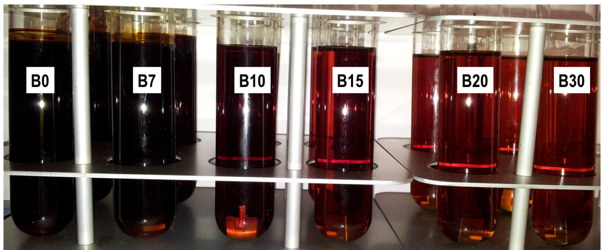
Abbildung 6.14: Abklingverhalten der FAME-Blends mit fossilem WB0-Referenzkraftstoff
