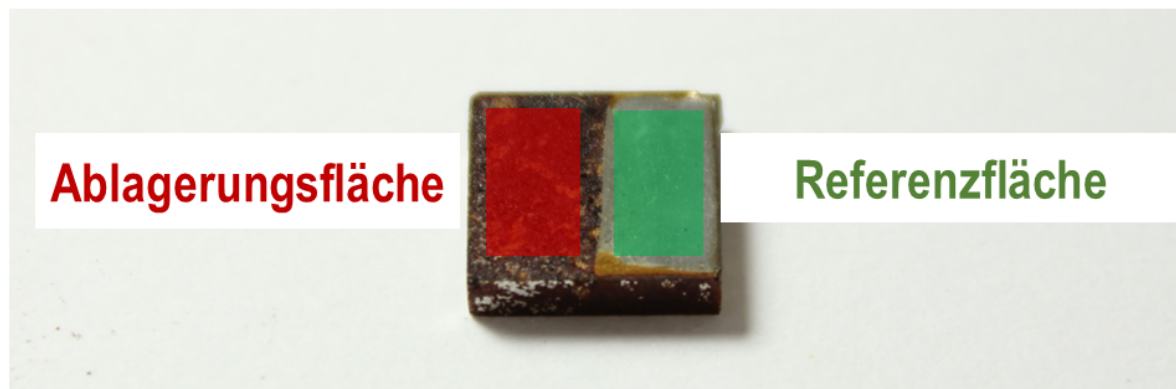
Abbildung 3.6: Relevante Seite: fertig behandelter Prüfkörper mit halbseitig aufgetragenen Ablagerungen und Referenzfläche
