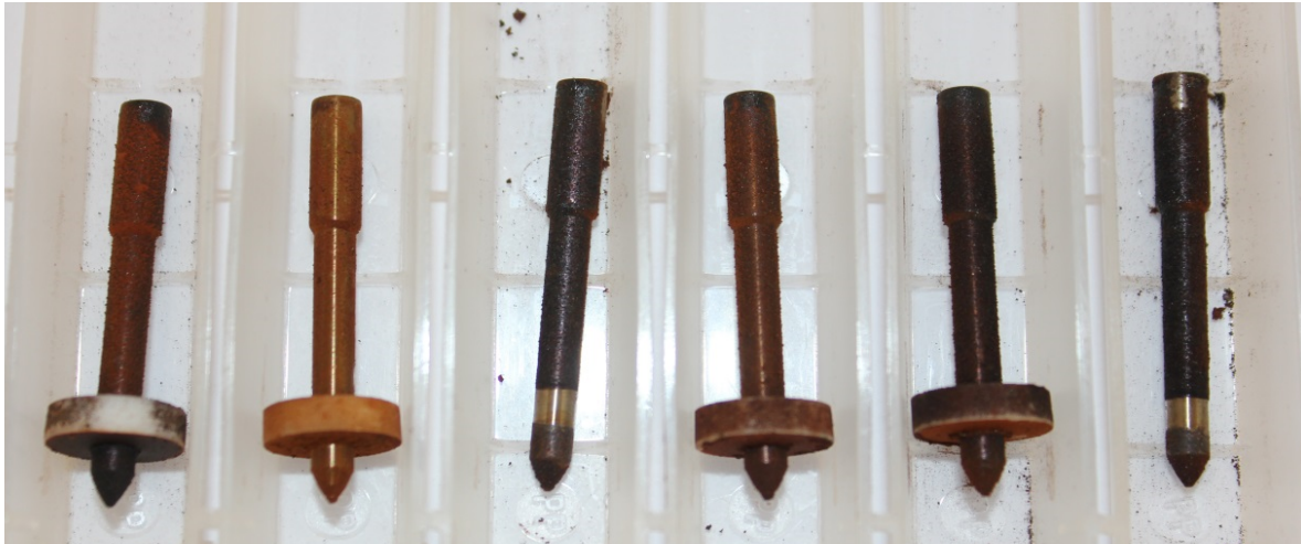
Abbildung 5.4: Eingeschränkte Reproduzierbarkeit bei sechs Düsenadeln eines Versuchs in fossilem DK vor der Optimierung des Versuchsaufbaus
