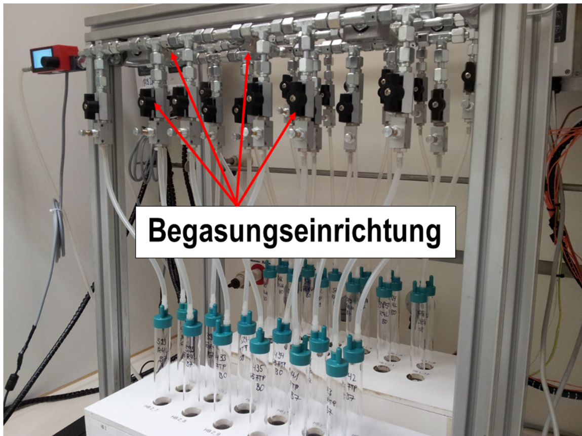
Abbildung 5.1: Geregelte Begasungseinrichtungen der Heizblöcke im Versuchsbetrieb
