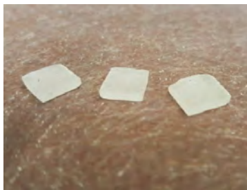
(a) Vorbereitete Preforms aus PCM
