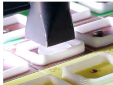
(c) Umschmelzen des Preforms
