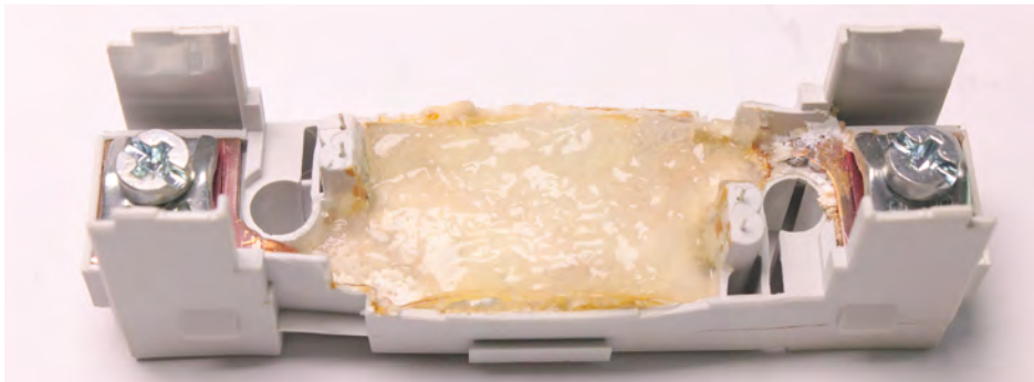
Abbildung 5.7.: Vergossener IGBT nach thermischer Alterung.
