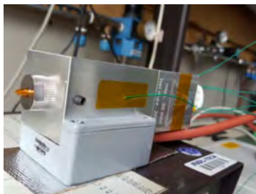
(a) Heizpatrone mit Teflon-Kartusche ( T_{max} = 180^{\circ}\text{C} )
