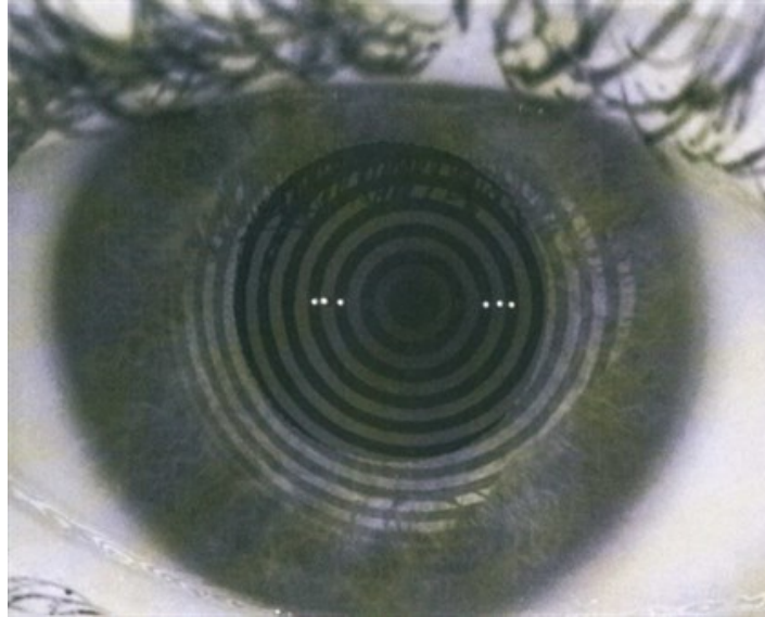
Abbildung 4: Darstellung der auf der Hornhaut des Probanden abgebildeten Placidoringe durch den Oculus ® Keratograph 5M.
