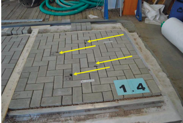
Abbildung 43: „Halbrundungen“ im Betonpflasterstein für die Probenahme des Fugenmaterials nach dem Verdichtungsvorgang zur Bestimmung des Wassergehaltes
