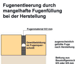
Abbildung 12: Schematische Darstellung zur Fugentleerung, hier oberflächlich gefüllte Fugen, wobei im Querschnitt Hohlräume vorhanden sind
