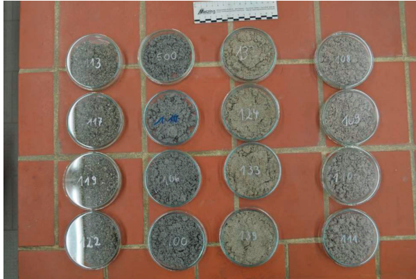
Abbildung 47: Proben vom Fugenmaterial der Prüfflächen Nr. 1.5.1, 2.5.1 und 3.5.1 sowie Bettungsmaterial aus Prüffläche Nr. 1.5.1 und 2.5.1 zur Bestimmung des Wassergehaltes
