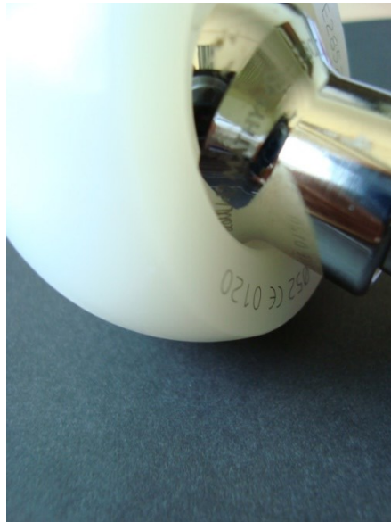
Abbildung 8: Kontaktfläche zw. PE und 28mm-Kopf/Konus, bei manchen Autoren als die dritte Artikulationsfläche genannt
