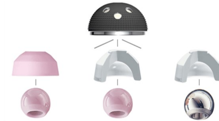
Abbildung 1: Gleitpaarungen in der modernen Hüftendoprothetik: Keramik-Keramik, Keramik-UHMWPE, Metall-UHMWPE nach [23]
