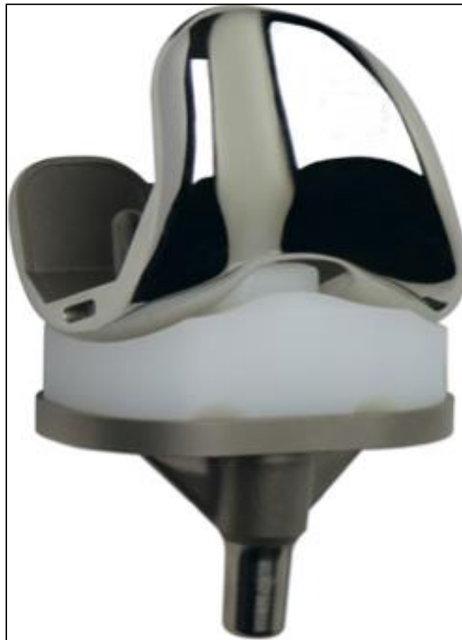
Abb. 6. Multigen Plus Knieendoprothese mit asymmetrischer metallischer Femurkomponente und „fixed bearing“-Inlay aus UHMW-Polyethylen (Lima Corporate, Villanova di San Daniele, Udine, Italien) (aus [5])
