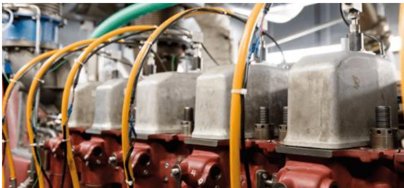
Abbildung 3-1: Versuchsträger der Motorprüfstandsversuche: mittelschnelllaufender 4-Takt-Schiffdieselmotor auf Basis eines Caterpillar MaK Typ 6M20 ausgerüstet als Forschungsmotor abweichend von der Serienkonfiguration
