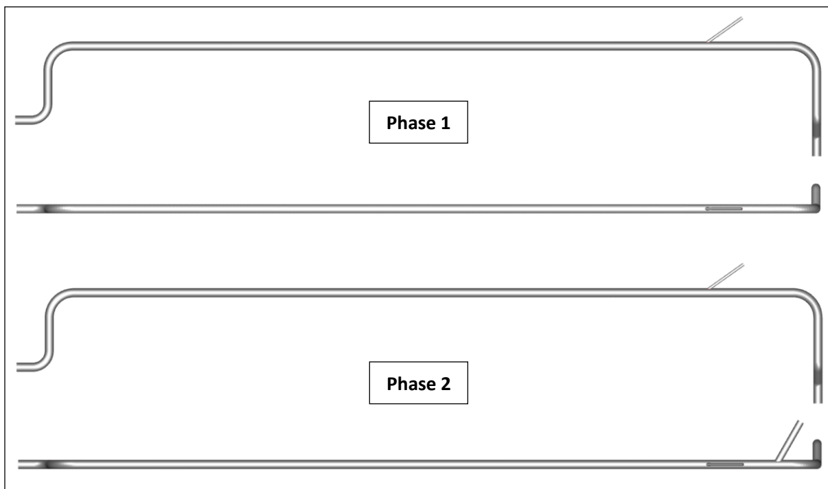
Abb. 4.14: Vereinfachte Strömungsnegative der beiden Versuchsphasen in Seitenansicht (jeweils oben) und Draufsicht (jeweils unten)
