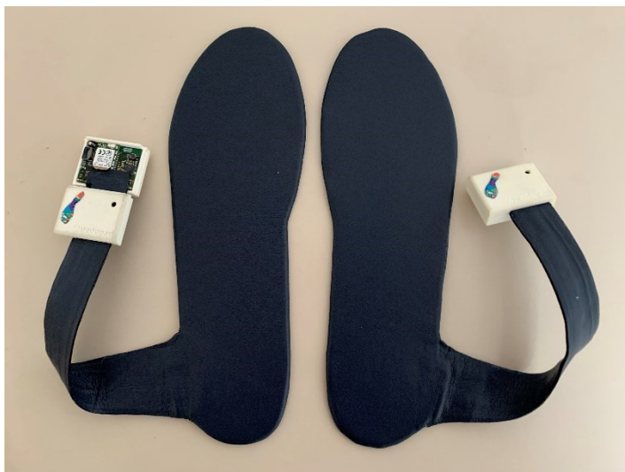
Abb. 8: loadsol®-Einlegesohlen mit geöffnetem Datentransmitter links
