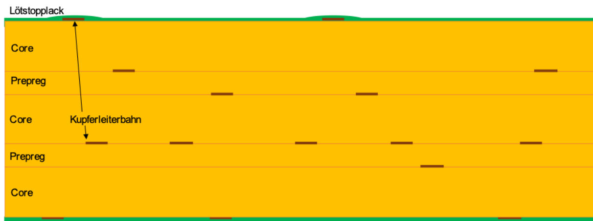
Abbildung 2: Standard Multi-Layer Leiterplatte mit 6 Lagen und beidseitig aufgetragenem Lötstopplack im Querschnitt. Die einzelnen Komponenten werden im Text erläutert.
