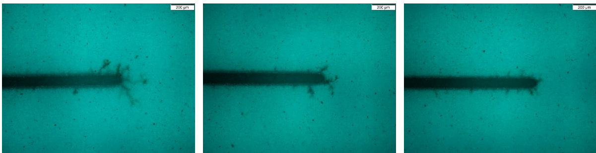
Abbildung 119: Senkrechte Aufsicht mit dem Lichtmikroskop im UV-Modus auf anodische Leiterbahnspitzen der Lackvariante G2.
