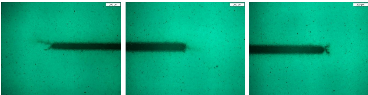
Abbildung 108: Senkrechte Aufsicht mit dem Lichtmikroskop im UV-Modus auf anodische Leiterbahnspitzen der Lackvariante E3.
