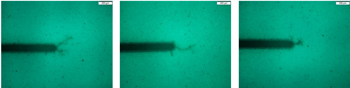
Abbildung 86: Senkrechte Aufsicht mit dem Lichtmikroskop im UV-Modus auf anodische Leiterbahnspitzen der Lackvariante H.
