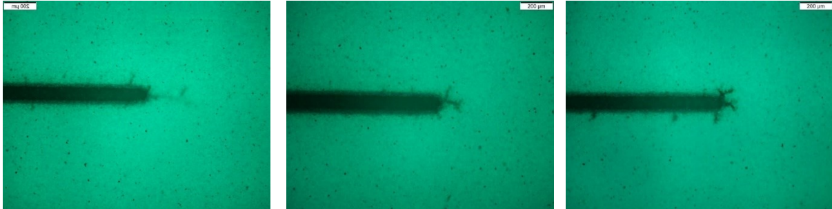
Abbildung 95: Senkrechte Aufsicht mit dem Lichtmikroskop im UV-Modus auf anodische Leiterbahnspitzen der Lackvariante E1.
