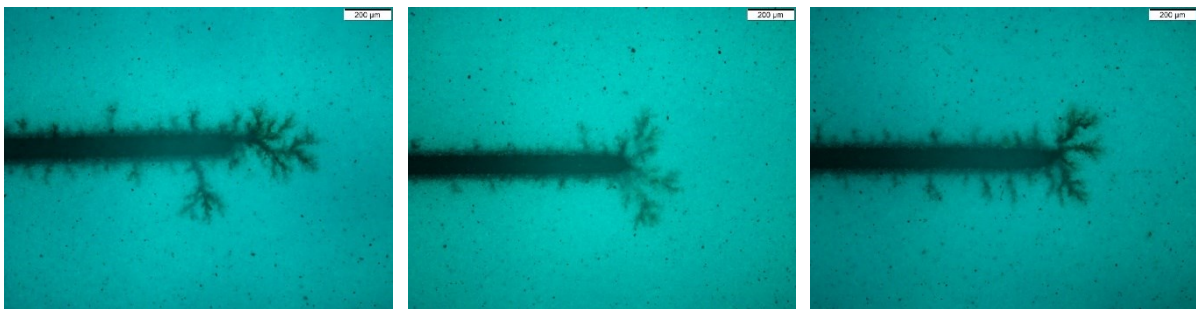
Abbildung 126: Senkrechte Aufsicht mit dem Lichtmikroskop im UV-Modus auf anodische Leiterbahnspitzen der Lackvariante G3.
