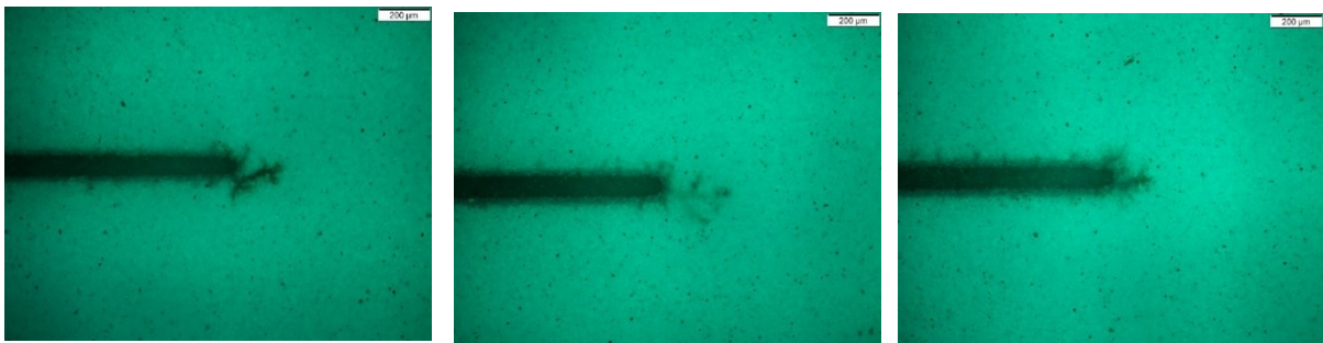
Abbildung 98: Senkrechte Aufsicht mit dem Lichtmikroskop im UV-Modus auf anodische Leiterbahnspitzen der Lackvariante D1.
