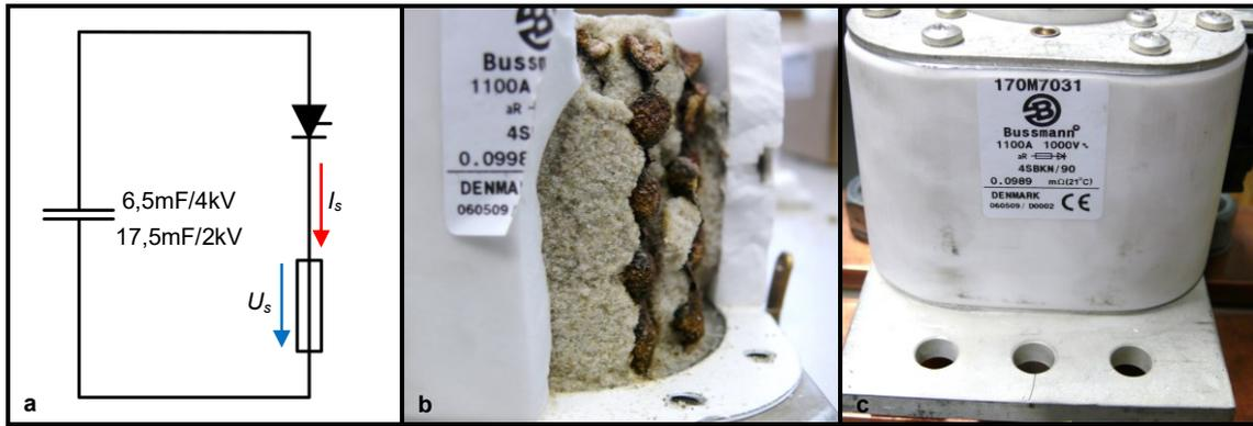
Abb. 1.5: Schaltung des Versuchsaufbaus (a) und Sicherungen nach den Versuchen an den (b) 6,5mF/4kV- bzw. (c) 17,5mF/2kV-Zwischenkreisen
