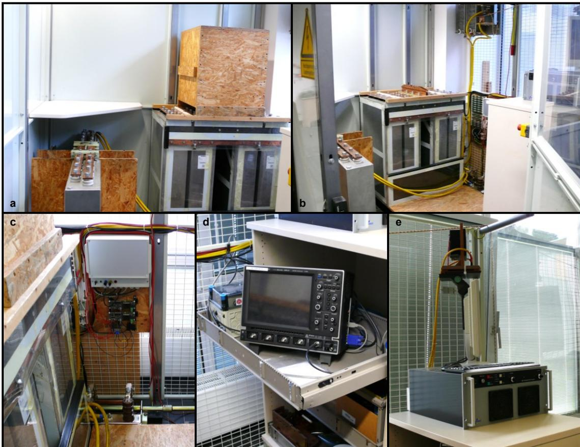
Abb. A.1: Ansichten des Prüfplatzes; a: 13mF/4kV-Zwischenkreis links, 9,5mF/5,5kV-Zwischenkreis rechts mit Splitterschutzhaube; b: oben mittig manuelle Entladeeinrichtung; c: Steuerungstechnik des Prüfstands und Erdungstrennschalter (unten); d: Oszilloskop; e: Kondensatorladegerät von Technix
