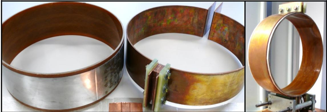
Abb. 4.2: RL-Transformator mit einer Windung und innenliegender Widerstandswicklung auf Trägerzylinder
