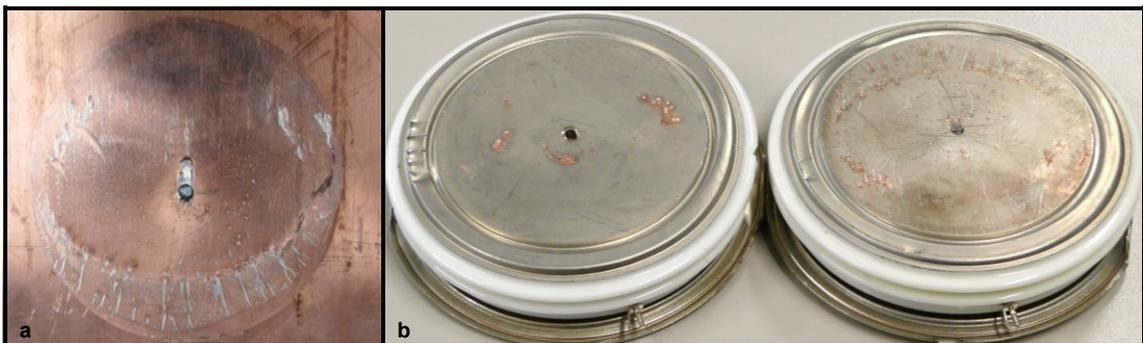
Abb. 2.12: Kontaktfläche auf dem Rückleiter (a) und Thyristorkontaktflächen nach dem Versuch (b)
