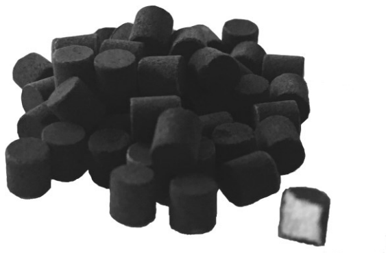
Abb. 3-1. Core-Shell Katalysatorpellets. Ruthenium zu 0.5 mass% beschichtet auf 5 mm x 5 mm (d x L) Pellets aus \gamma -Aluminiumoxid.
