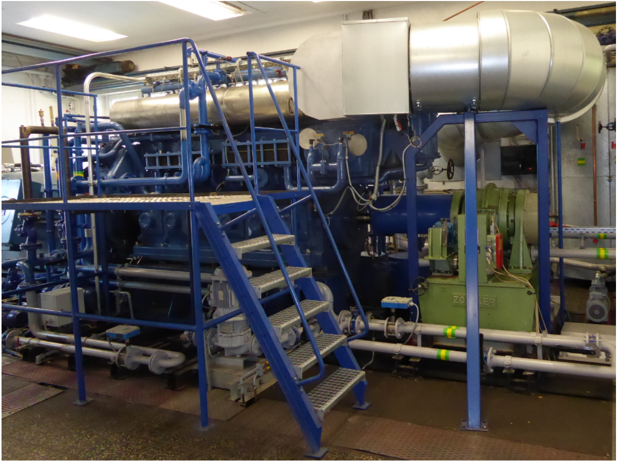
Abbildung B.1: Motorprüfstand MAN B&W 6L23/30 mit Wasserwirbelbremse
