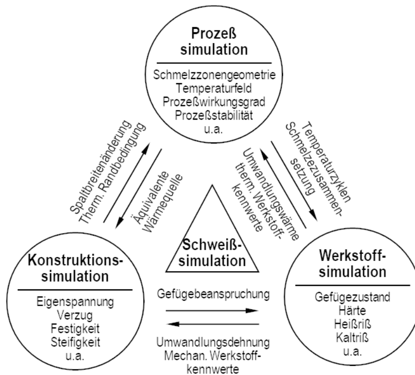
Abbildung 10: Teilsimulationen mit wesentlichen Wechselwirkungen nach Radaj [69].
