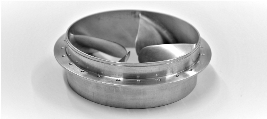
Abbildung 4.1: Untersucher, nabenloser Propeller.
