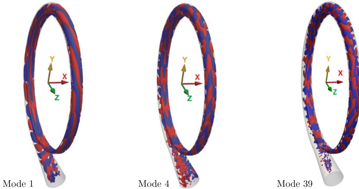
Abbildung 1.6: Iso-Fläche der radialen Komponente der POD -Geschwindigkeitsmode 1, 4 und 39 im Spiralgehäuse einer einstufigen Radialpumpe ( Witte et al. (2018) ). Rot: M_{p,1} \cdot \sqrt{D^2} = 1 ; Blau: M_{p,1} \cdot \sqrt{D^2} = -1 .
