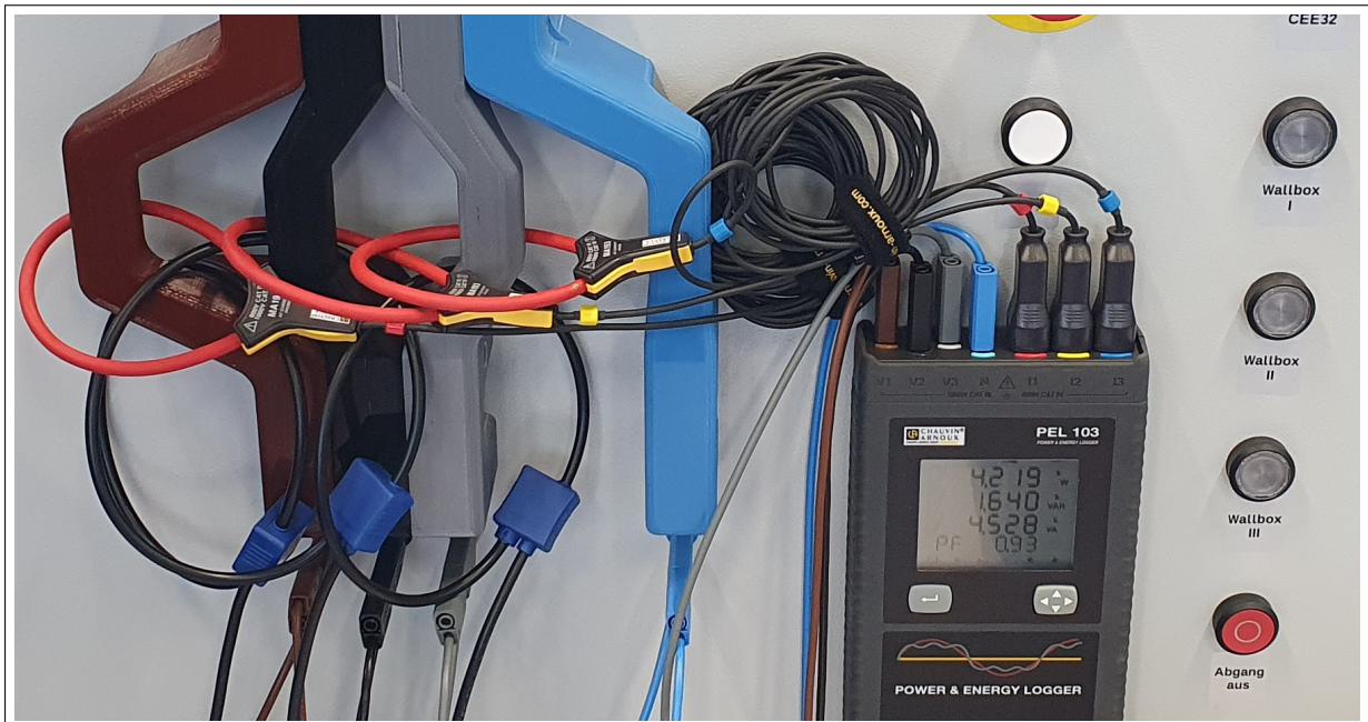
Abb. C.13: Ankopplung der Messwandler mit Referenzmessgerät. Links: Rogowski-Spulen des Laborprototypen und Stromwandler des Referenzmessgeräts. Darunter: Ankopplung der Spannungsmessung über geschützte 4 mm-Klemmen. Rechts: Referenzmessgerät.
