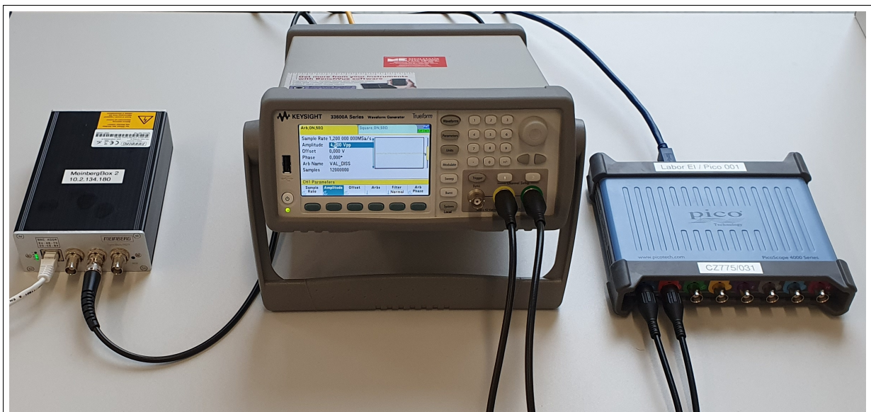
Abb. C.14: Validierung des Laborprototypen. Referenzsignalgenerator (links), Tongenerator (mitte), PicoScope 4824 (ADU, rechts).
