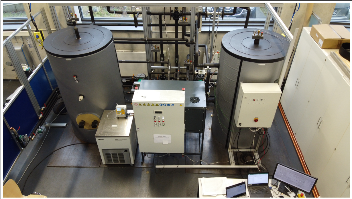
Abb. C.15: Kompressionskältemaschine (Mitte) mit umgebendem Prüfstand. Der in Kapitel 6 beschriebene Messplatz befindet sich unmittelbar links davon. 1
