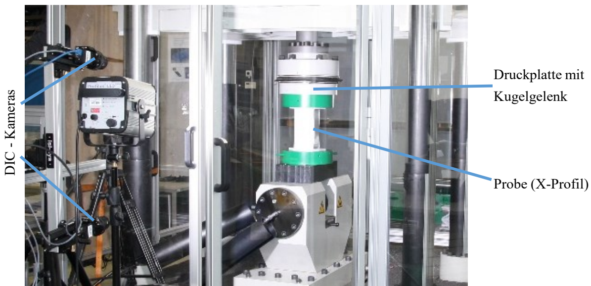
Abbildung 6-2: Versuchsaufbau für Axialdruckversuche mit vertikal angeordneten DIC-Kameras [103]
