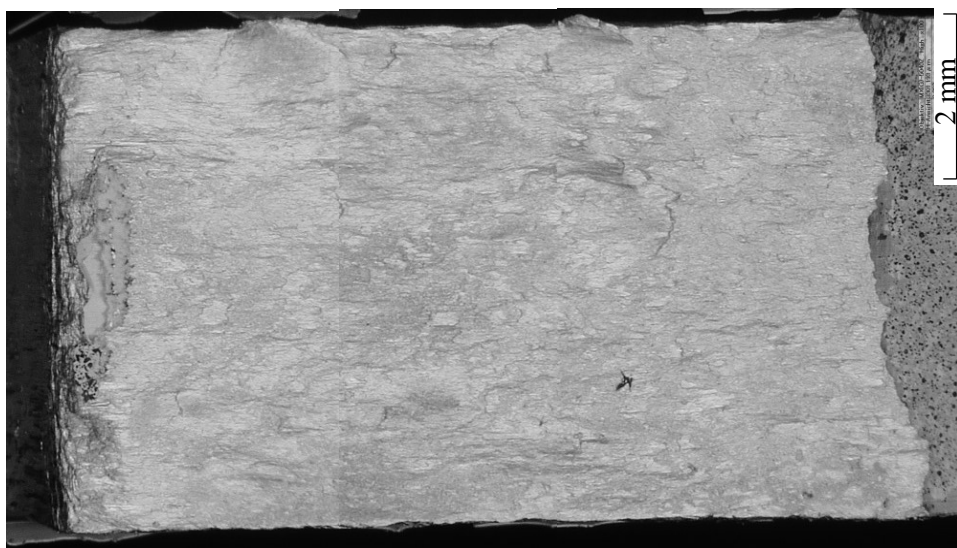
Abbildung A 7: Bruchflächen von asymmetrischen Schubproben nach Versuchen mit Lastwinkeln 0^\circ , 15^\circ und 30^\circ
