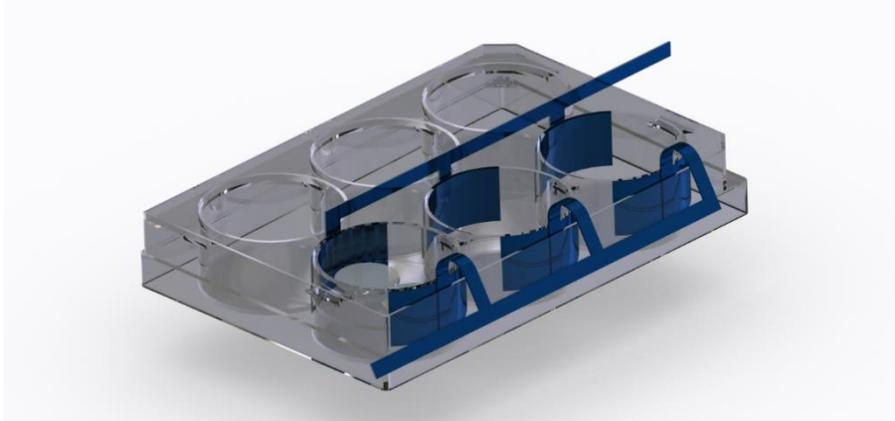
Abb. 4-2: 3D-Darstellung der 6-Well-Zellkulturplatte aus Polystyrol mit eingearbeiteten Ti6Al4V-Elektroden. Im vorderen rechten Well ist zusätzlich eine mit zwei Kollagen-Scaffolds beladene Petrischale dargestellt.
