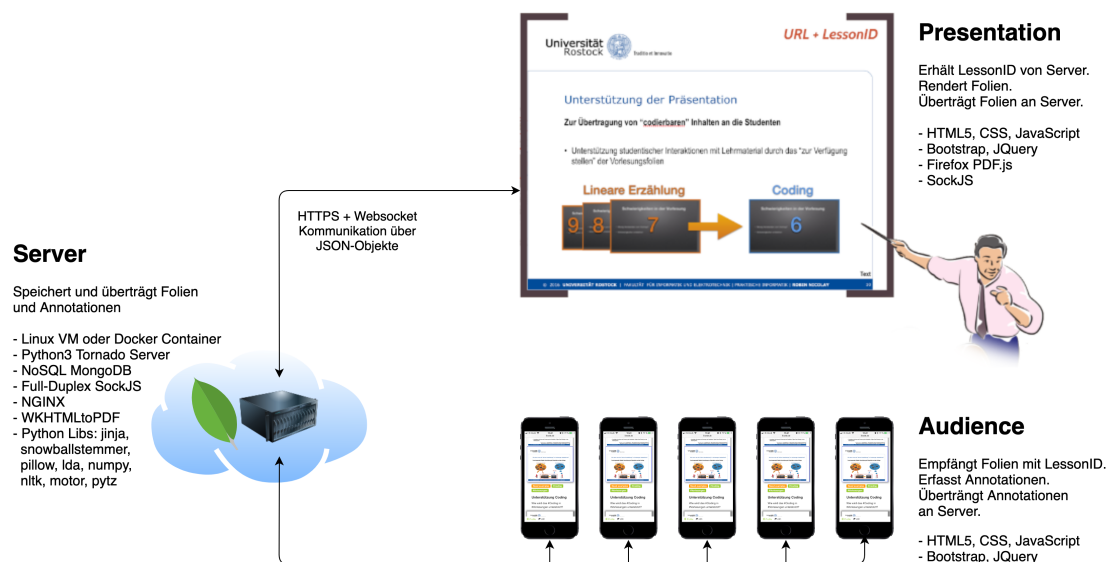
ABBILDUNG 32: ÜBERBLICK ÜBER DEN AUFBAU DES SCARLETT-PROTOTYPEN ZUR ERFASSUNG VON LEHR- UND CODING-PROZESSEN IN VORLESUNGEN.
