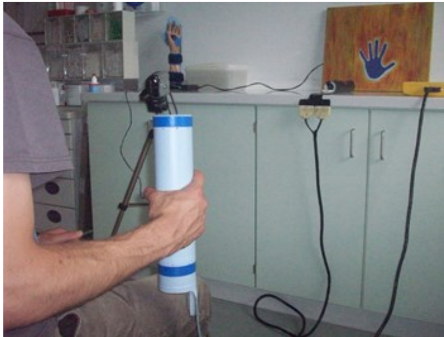
Abb. 4: Messposition beim Greifen des großen Zylinders (200 mm Umfang). Im Hintergrund auf dem Schrank liegt der kleine Zylinder (150 mm Umfang).
