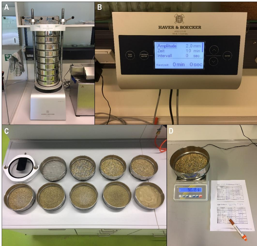
Abb. 6: Durchführung der trockenen Siebanalyse im Labor der Universität Rostock. A = Einsatzbereiter Siebturm, B = Anzeige und Bedienfeld der Siebmaschine, C = Zerlegter Siebturm mit Futterbestandteilen nach erfolgter Siebung, D = Wägung einer Siebebene mit Futterbestandteilen
