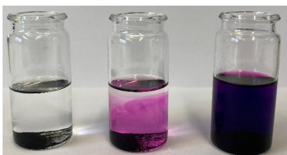
Abbildung 1.4. Ungelöstes \text{KMnO}_4 in \text{CH}_2\text{Cl}_2 (links). \text{KMnO}_4 in \text{CH}_2\text{Cl}_2 nach der Zugabe von DCH-18-C-6 (mitte) und vollständig gelöstes \text{KMnO}_4 in \text{CH}_2\text{Cl}_2 im Beisein von DCH-18-C-6 (rechts).
