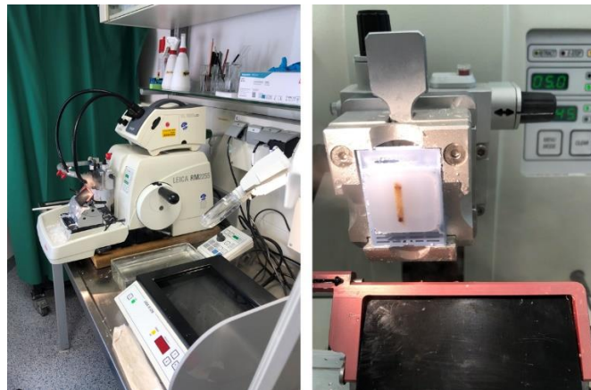
Abbildung 3 Rotationsmikrotom und Wirbelkörperstanze im Paraffinblock
