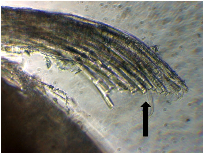
Abbildung 28 SERAFIT® 0 nach 10 Wochen - Bruch der Stränge des Fadens, 20x vergrößert, Kamera: AxioCamMR3.
