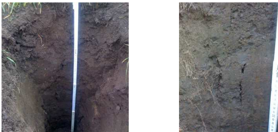
Abb. 82: Durch Schrumpfungsrisse gekennzeichnete Bodenprofile am Testfeld A der Messpunkte Nr. 2 und Nr. 8 mit auftretender erhöhter Infiltrationsrate (SCHARFENBERG 2013)
