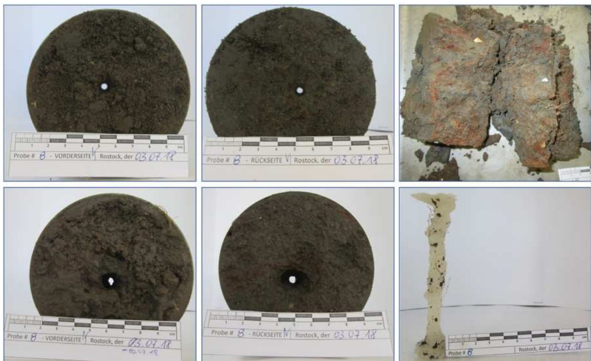
Abb. 125: HET #8 - Zustand der Probe vor und nach der Versuchsdurchführung
