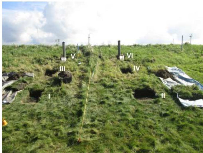
Abb. 55: Infiltrometerversuch am Querschnitt E - Messpunkte (Okt/Nov. 2017)
