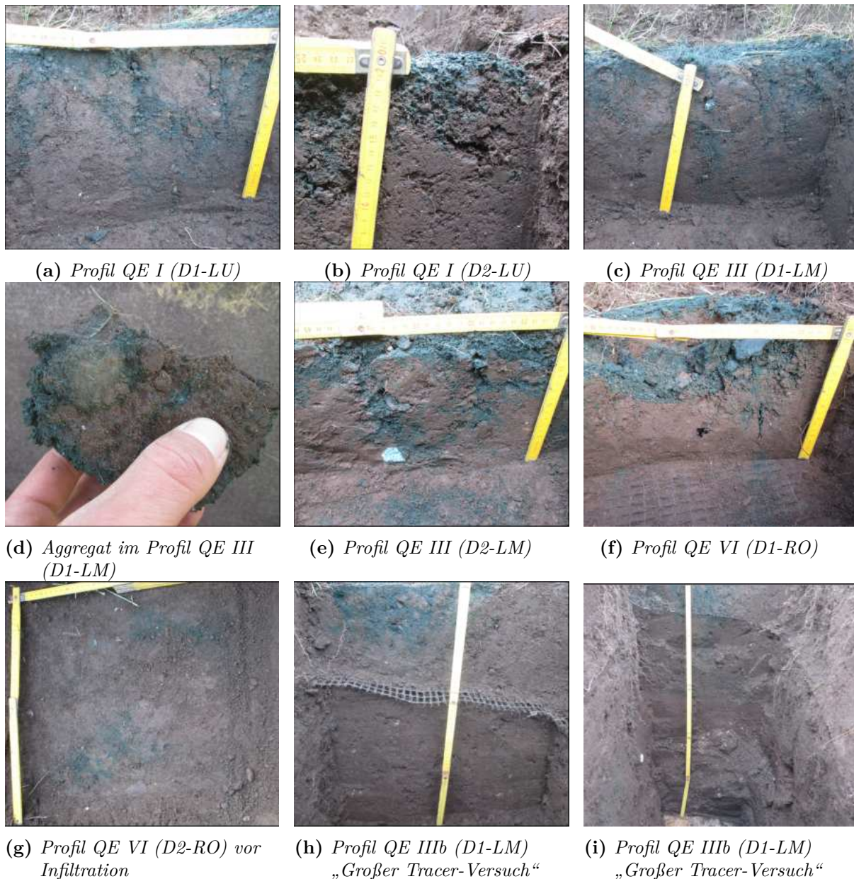
Abb. 86: Nach den Infiltrationsversuchen aufgegrabene Profile im Querschnitt E (wasserseitige Deckschicht, Ostdeich)
