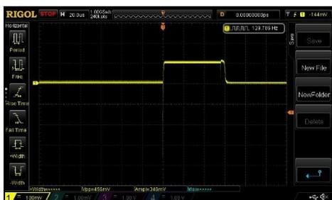
Abbildung 28: Oszilloskopmessung intrakorporaler Stimulator während der Verkapselung. Darstellung eines Rechteckimpulses (130 Hz)
