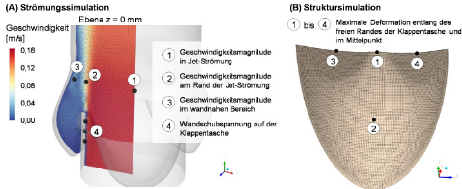
Abb. 48: Definierte Punkte zur Analyse der notwendigen Elementanzahl der Fluid- und Strukturumgebung für eine unabhängige Lösung der jeweiligen Feldgrößen.
