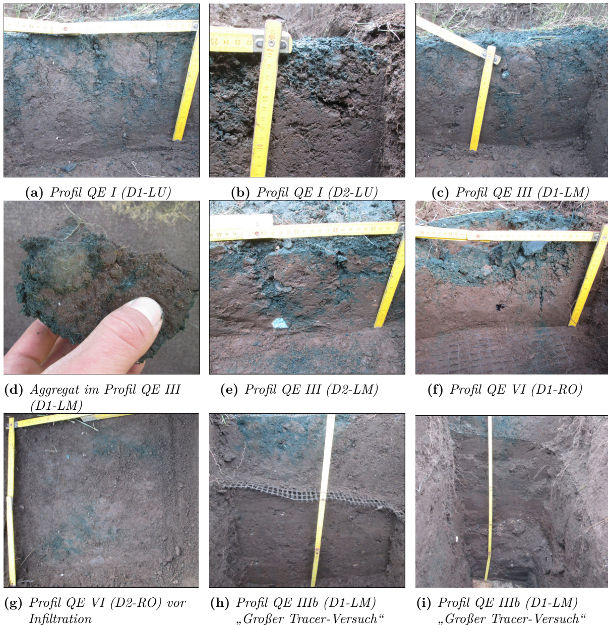
Abb. 86: Nach den Infiltrationsversuchen aufgegrabene Profil im Querschnitt E (wasserseitige Deckschicht, Ostdeich)
