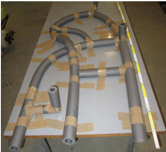
(a) Videoendoskopie in einem künstlichen Röhrensystem
