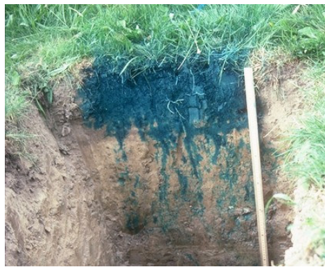
Abb. 26: Beispiel für unterschiedliche Arten der Wasserbewegung im Boden mit homogenen (durchlässigen) Matrixfluss in der Verteilungszone des Oberbodens und einem präferentiellen Fluss im Unterboden (SOIL & WATER LAB 2003)
