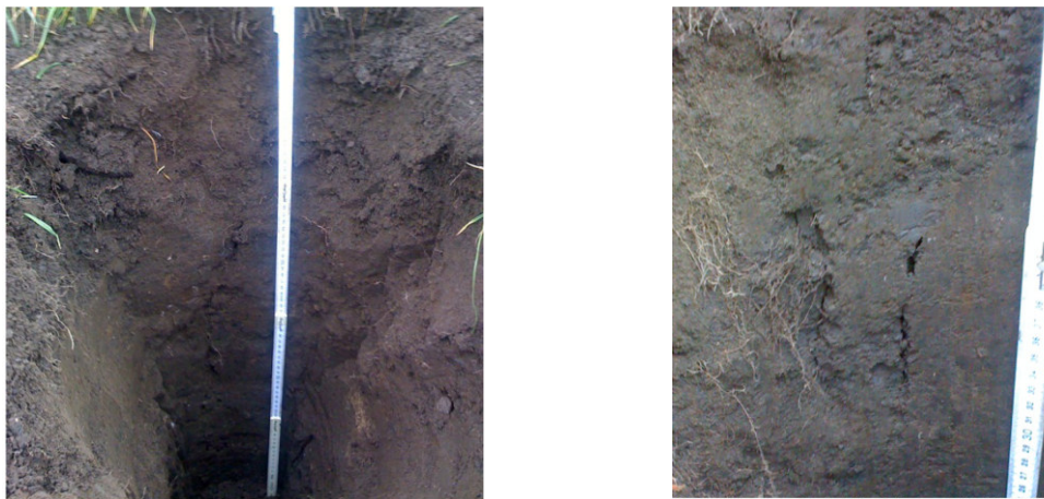
Abb. 82: Durch Schrumpfrisse gekennzeichnete Bodenprofile am Testfeld A der Messpunkte Nr. 2 und Nr. 8 mit auftretender erhöhter Infiltrationsrate (SCHARFENBERG 2013)
