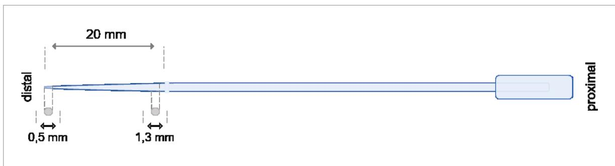
**Abb. 6** Schematische Darstellung des verwendeten Cochlea-Katheters (MED-EL). Gesamte Länge: 150 mm, Länge Insertionsteil: 20 mm, Durchmesser distal: 0,5 mm, Durchmesser proximal: 1,3 mm.
