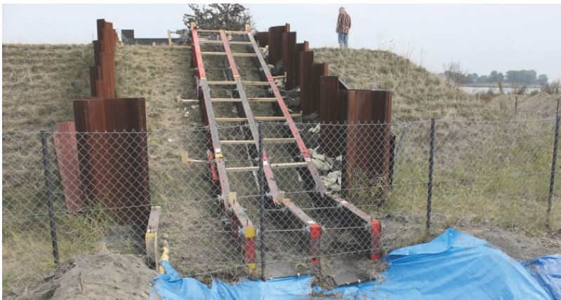
Abbildung 4-10. Standardaufbau der Rinnen für die Überströmungsversuche auf dem Danziger Forschungsdeich. Zwei parallele Rinnen: Länge 6,70 m, Breite 0,6 m, Anzahl Testabschnitte (TA) 9; Länge TA 0,74 m.
