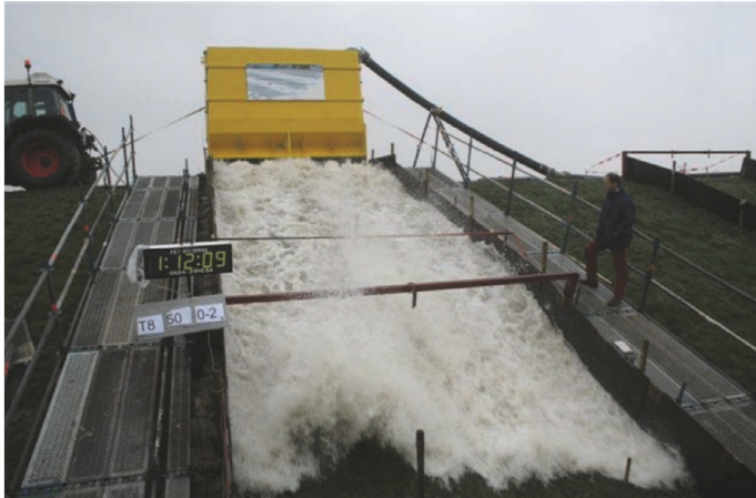
Abbildung 3-19: Wellüberlaufsimulator während eines Versuchs, bei dem 14 \text{ m}^3 Wasser innerhalb weniger Sekunden über die Deichböschung geleitet werden (Foto: Van der Meer et al. (2007))
