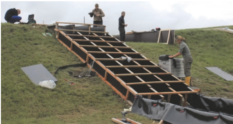
Abbildung 4-7. Standardaufbau der Rinnen für die Überströmungsversuche auf dem Rostocker Forschungsdeich: Drei parallele Rinnen, die Querlatten dienen sowohl als Fixierung als auch als Markierung für verschiedene Messungen.
