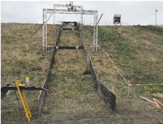
Abbildung 3-9: Versuchsaufbau der Polders2C 's-Überströmungsversuche (Foto: Koelewijn et al. 2022).
