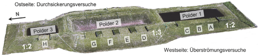
Abbildung 4-2. Versuchsdeich in Rostock: Polder 1 mit den Querschnitten A, B und C; Polder 2 mit den Querschnitten D, E, F und G und Polder 3 mit Querschnitt H. Gesamtlänge 125 m, Gesamtbreite über beide Deiche 45 m, Höhe 3,30 m. 3-D Fotomodell, Darstellung nach Cantré et al. 2014.
