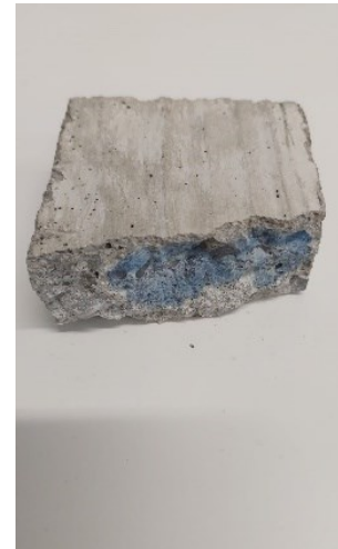
Abbildung 61: Zerbrochene Probe U6 mit aufgetragener Tinte
