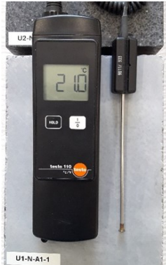
Abbildung 49: Bestimmung der Oberflächentemperatur
