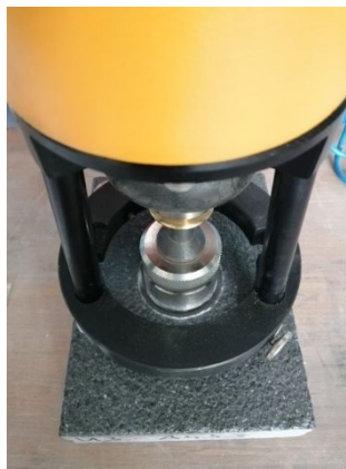
Abbildung 64: Prüfung der Haftzugfestigkeit
