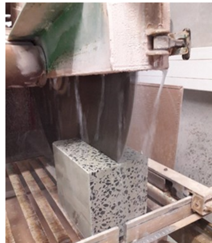
Abbildung 18: Sägen der Mauerscheibe
