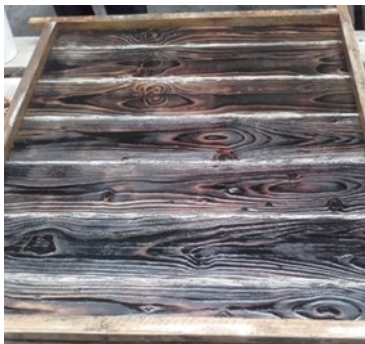
Abbildung 21: Form zur Herstellung der Platte (Foto: V. Fröschke)
