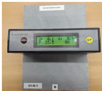
Abbildung 38: Glanzmessung mit dem Reflektometer auf dem Untergrund U1
