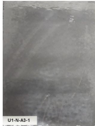
Abbildung 55: Opake Erscheinung des AGS3 auf U1 nach der Trocknung U1
