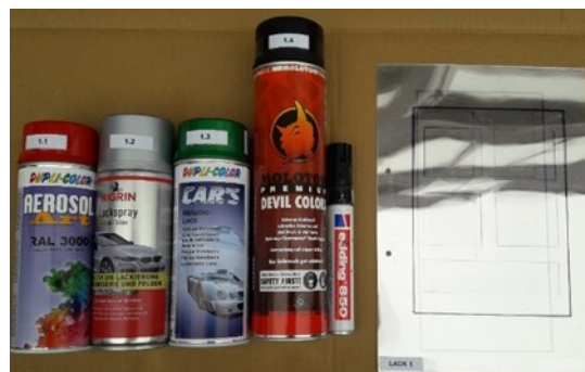
Abbildung 70: verwendete Farbmittel des 1. Zyklus und Schablone zum Auftragen
