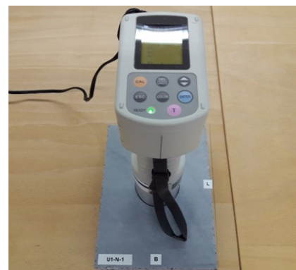
Abbildung 39: Helligkeitsmessung mit dem Chroma Meter CR – 410 auf dem Untergrund U1
