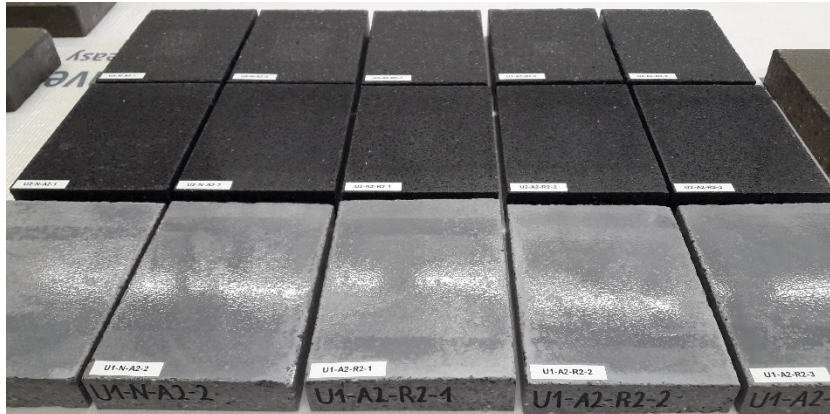
Abbildung 53: Untergründe U1 bis U3 direkt nach dem ersten Auftrag des AGS 2
