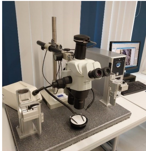
Abbildung 60: Olympus-Mikroskop SZX 16 für die Bestimmung der Eindringtiefe
