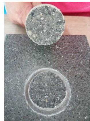
Abbildung 65: Bruch im Untergrund 3 mit AGS3
