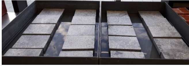
Abbildung 45: Wasserbehälter mit Prüfkörpern zur Ermittlung des Wasseraufnahmekoeffizienten
