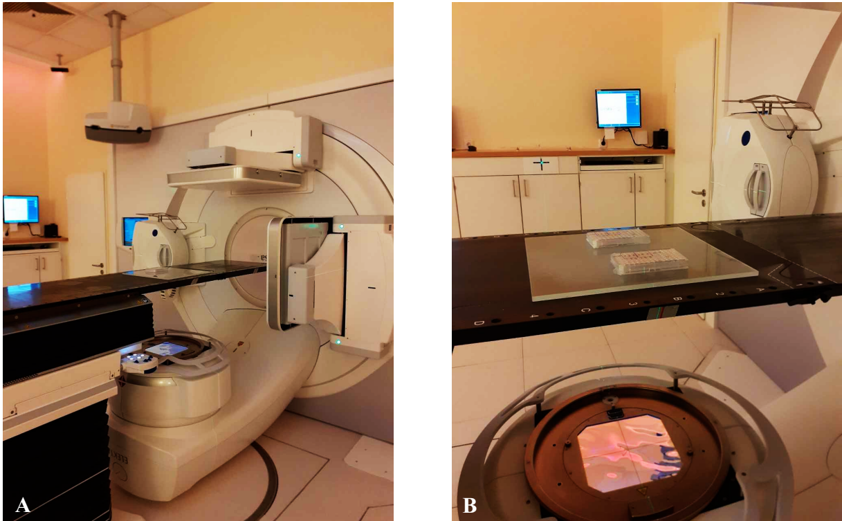
Abb. 3: A) Der Linearbeschleuniger Elekta VersaHD der Klinik und Poliklinik für Strahlentherapie der Universitätsmedizin Rostock, mit welchem die Bestrahlungen durchgeführt wurden; B) Beispielhafter Aufbau der Bestrahlung einer 96-Wellplatte.
